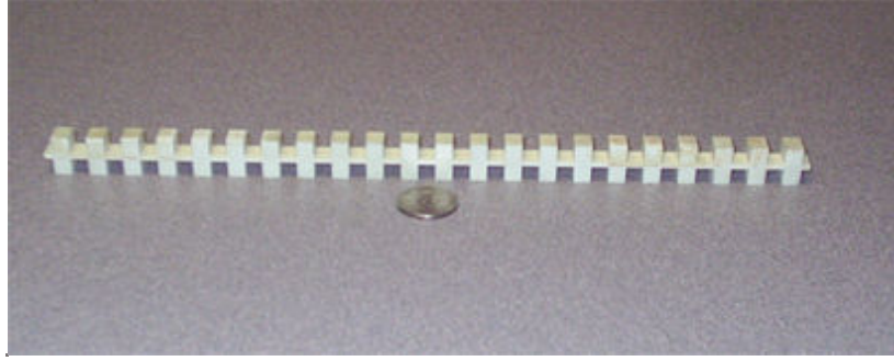
Şekil 6.6 22 birim hücreli yarı periyodik dielektrik malzemenin yandan görünüşü
