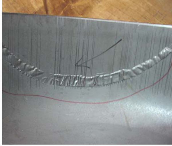
Şekil 4.126 : Nihai üretim aşamasında yüzeyde kat şeklinde çizgisel ayrılmalar görülen malzeme.
