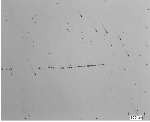
Şekil 4.93 : Sıcak haddeleme sonrası \text{Al}_2\text{O}_3 inklüzyonları (Optik Mikroskop, 100X).
