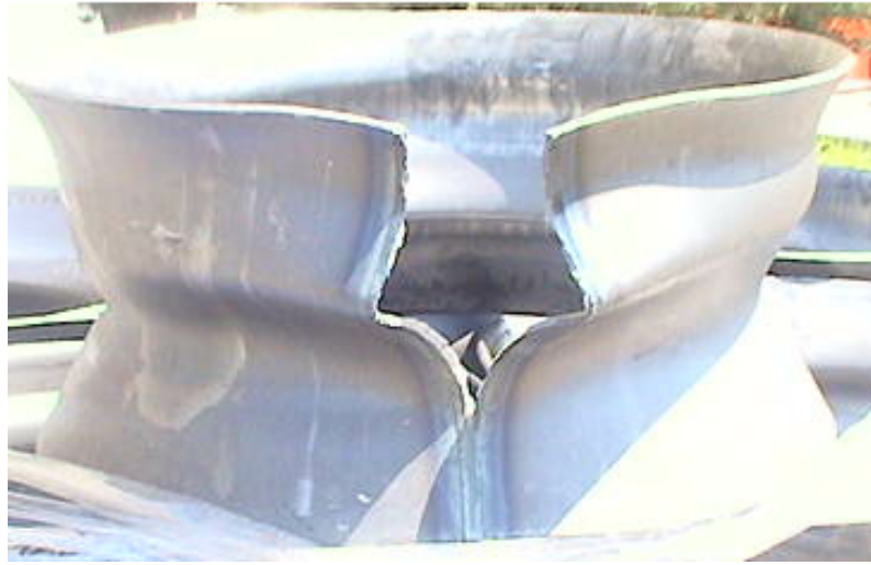
Şekil 4.113 : Kaynak işlemi sırasında çatlak oluşumu görülen jant malzemesi
