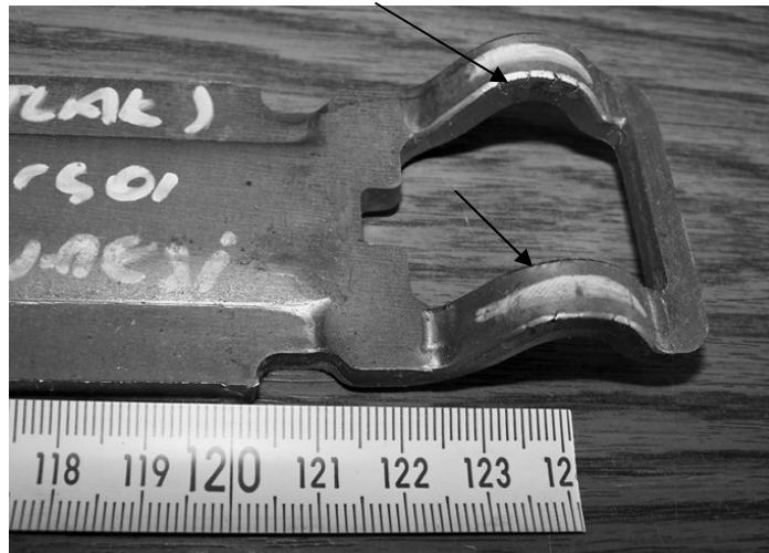
Şekil 4.119 : Şekillendirme sırasında çatlak oluşumu görülen malzeme.
