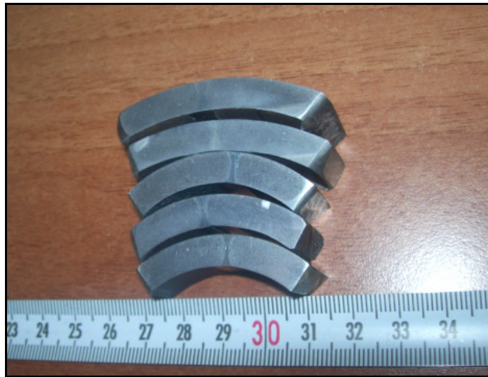
Şekil 4.116 : Kaynak bölgelerinden çıkarılan kesit numunelerine ait genel görünüm.
