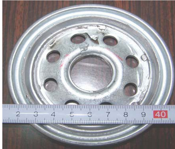
Şekil 4.122 : Nihai üretim aşamasında yüzeyde kat şeklinde ayrılma görülen jant malzemesi.
