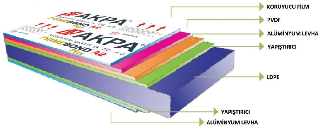
Şekil 4.1 : AKPA BOND A2 alüminyum kompozit panelin katmanlı yapısı.
