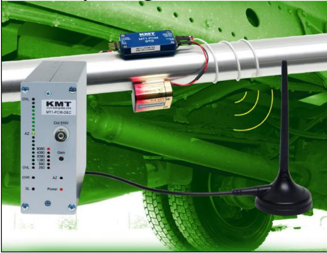
Şekil 4.8: Telemetri sistemiyle gerçek araç üzerinden tork datası toplanması.
