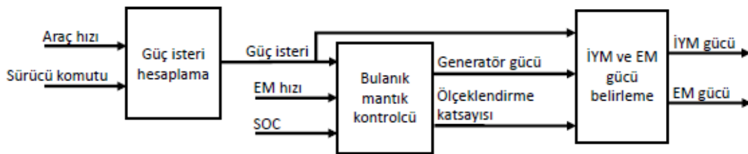
Şekil 3.2 : Kontrolcü blok şeması [33].
