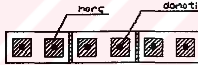
Şekil 4.2 Altı donatılı numunelerde donatı yerleşimi
