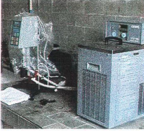
Şekil 3.3.3.1 Viskometre ile Kriyostat
