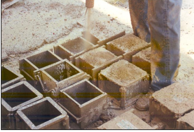
Şekil 4.7 Çimento - toprak karışımın kalıplara püskürtülmesi
