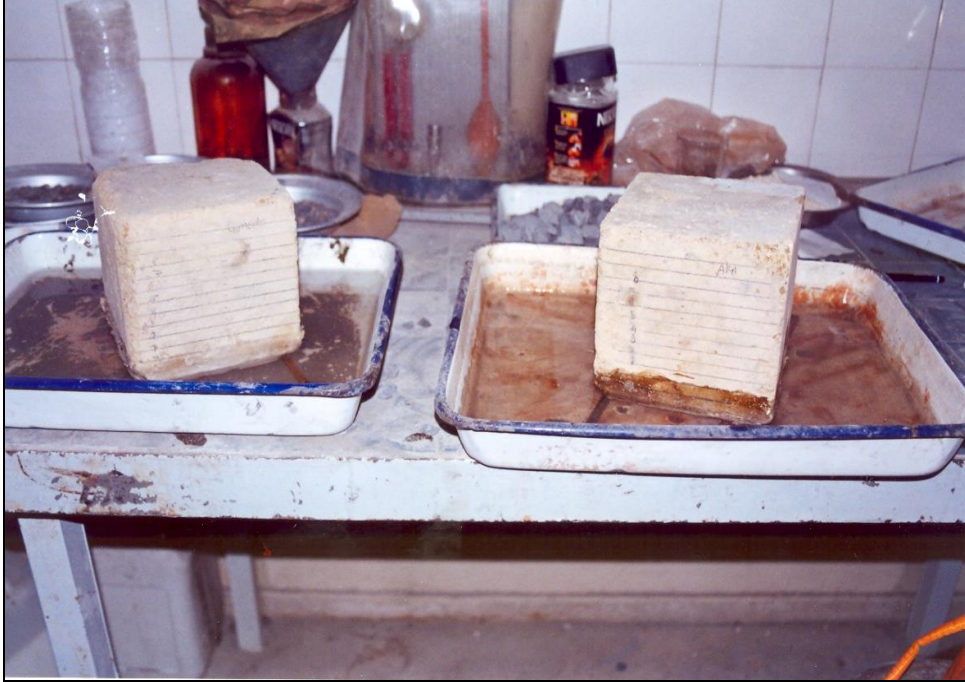
Şekil 5.7 Numunelerin su dolu kaba oturtulması
