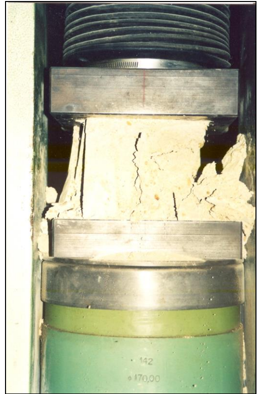
Şekil 5.29 Su emen çimento katkılı toprak numunede basınç dayanımı deneyi
