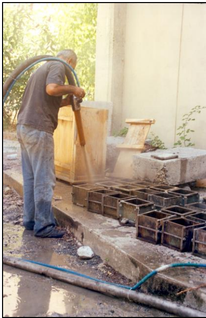
Şekil 4.6 Alçı - toprak karışımının kalıplara püskürtülmesi ve malalanması
