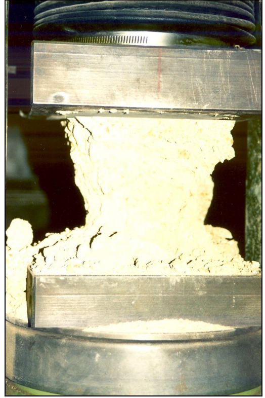
Şekil 5.28 Su emen alçı katkılı toprak numunede basınç dayanımı deneyi
