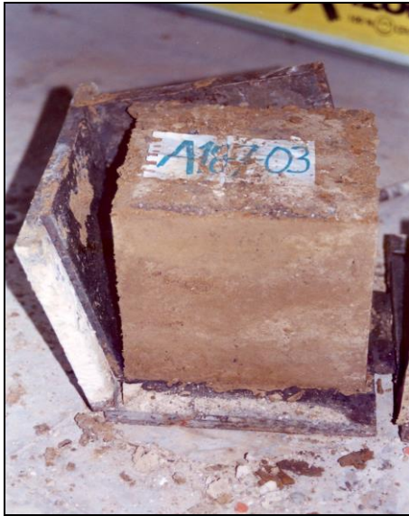
Şekil 4.8 Kalıptan çıkarılan alçı katkılı toprak numune
