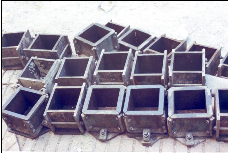
Şekil 4.1 Temizlenip yağlanarak püskürtmeye hazırlanan çelik kalıplar
