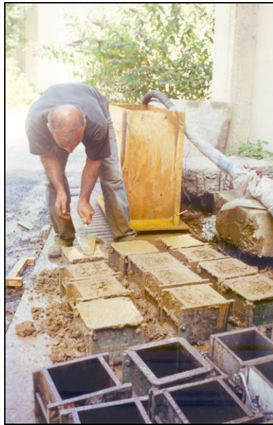
Şekil 4.6 Alçı - toprak karışımının kalıplara püskürtülmesi ve malalanması
