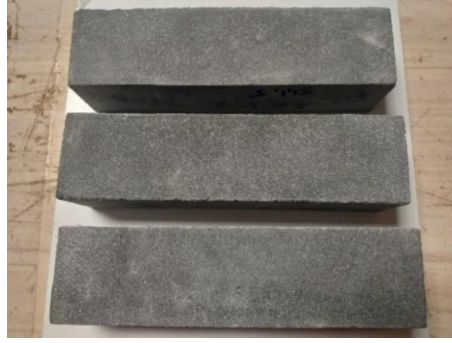
Şekil 3.120 : AR1-1-K numuneleri, donma-çözülme çevrimleri sonrası görünüm.
