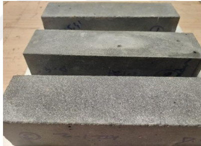
Şekil 3.122 : AR1-2-K numuneleri, donma-çözülme çevrimleri sonrası görünüm.
