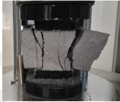
Şekil 3.93 : AR2-3-K numunesi, 28 günlük basınç dayanım testi.
