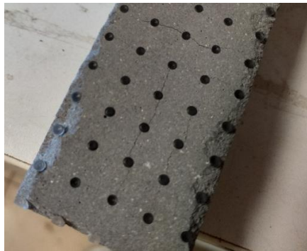
Şekil 3.62 : 150 °C sıcaklığa maruz kalmış numune.
