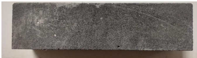
Şekil 3.124 : AR1-3-K numunesi, donma-çözülme çevrimleri sonrası görünüm.
