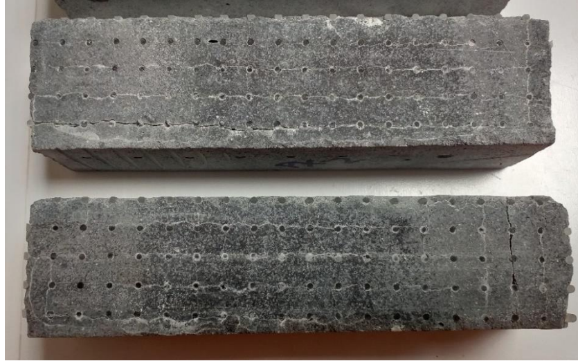
Şekil 3.142 : PMMA tüp doğrultularında yatay ve düşey yönde oluşan çatlaklar.
