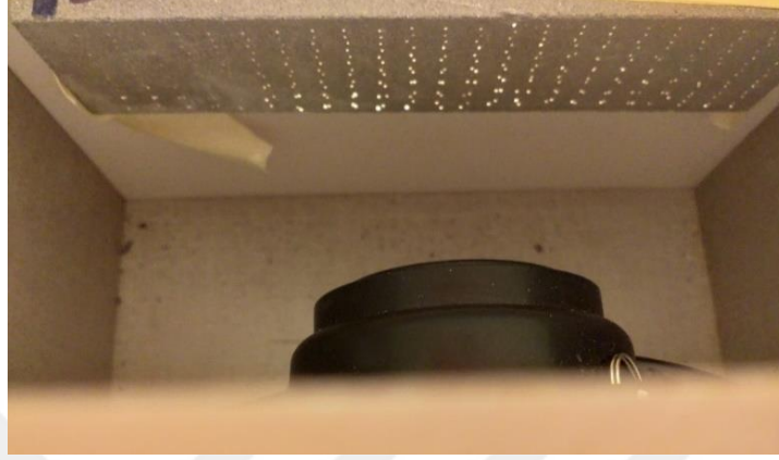
Şekil 3.128 : AR1-1-K numunesi, yüksek sıcaklık sonrası ışık geçirgenlik deneyi.
