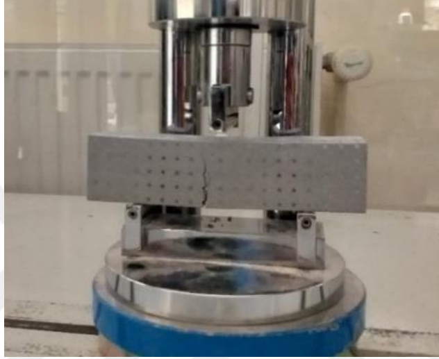
Şekil 3.95 : PX grubu numunesi, 28 günlük eğilme dayanım testi.
