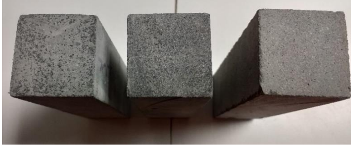
Şekil 3.115 : AR1-2-U numuneleri, ıslanma-kuruma çevrimleri sonrası görünüm.
