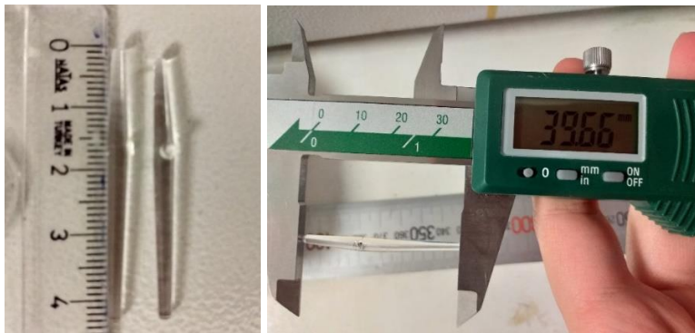
Şekil 3.59 : 110 °C sıcaklıktan sonra PMMA tüplerde kısalma.
