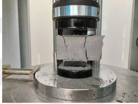
Şekil 3.88 : Numuneye uygulanan basınç dayanımı testi (AR1-2-K).
