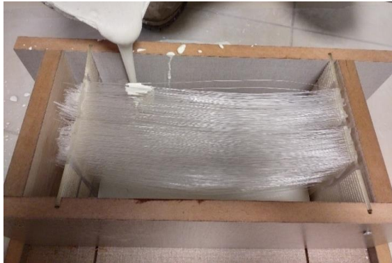
Şekil 3.10 : Deneme üretimi, döküm yapılması.
