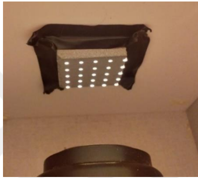
Şekil 3.97 : PX grubu numunesi, ışık geçirgenlik testi.
