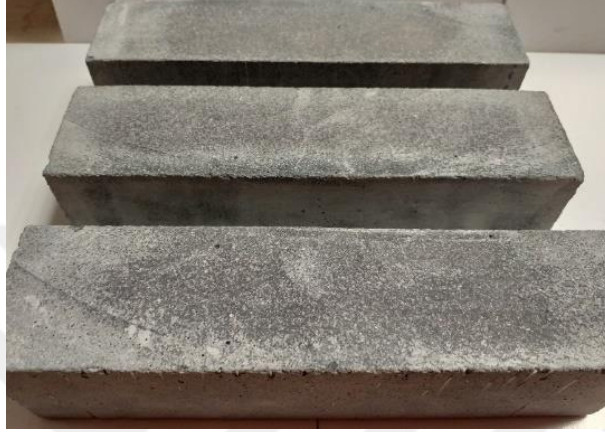
Şekil 3.116 : AR1-2-K numuneleri, ıslanma-kuruma çevrimleri sonrası görünüm.
