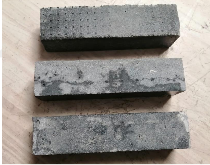
Şekil 3.145 : Numunelerin donma-çözülme çevrimleri sonrası görünüşleri.
