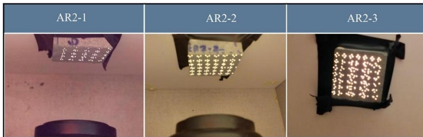
Şekil 3.94 : AR2 grubu numuneleri, ışık geçirgenlik testi.
