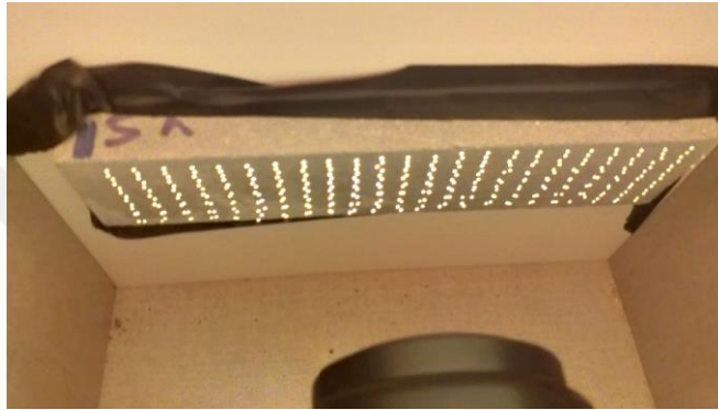
Şekil 3.127 : AR1-1-K numunesi, yüksek sıcaklık etkisi öncesi ışık geçirgenlik deneyi.
