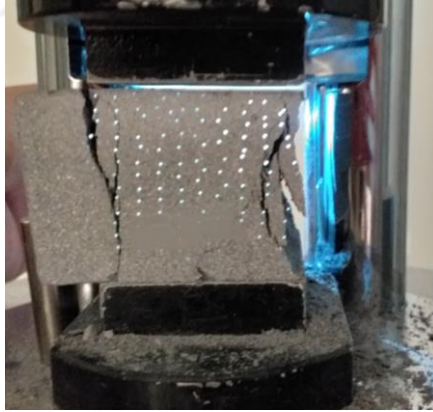
Şekil 3.76 : AR1-2-K numunesi, 28 günlük basınç dayanım testi.
