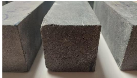
Şekil 3.123 : AR1-2-U numuneleri, donma-çözülme çevrimleri sonrası görünüm.
