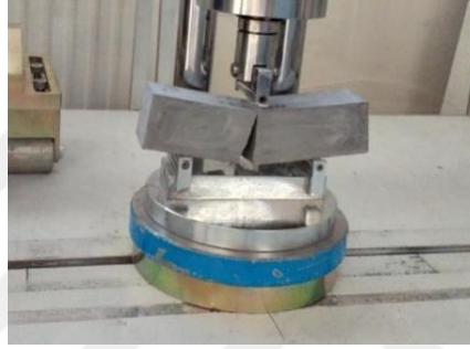
Şekil 3.71 : REF grubu, 28 günlük eğilme dayanım testi.
