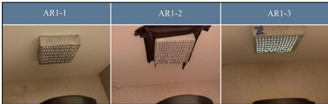
Şekil 3.79 : AR1 grubu numuneleri, ışık geçirgenlik testi.
