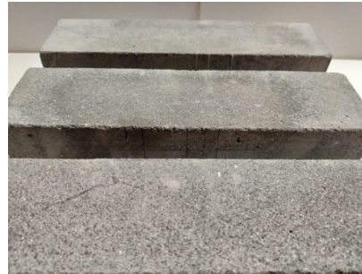
Şekil 3.114 : AR1-1-K numuneleri, ıslanma-kuruma çevrimleri sonrası görünüm.
