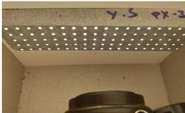
Şekil 3.146 : Yüksek sıcaklık sonrası uygulanan ışık geçirgenliği testi.
