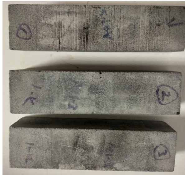
Şekil 3.118 : AR1-3-K numuneleri, ıslanma-kuruma çevrimleri sonrası görünüm.
