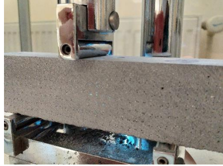
Şekil 3.87 : Numuneye uygulanan eğilme dayanımı testi (AR1-2-K).
