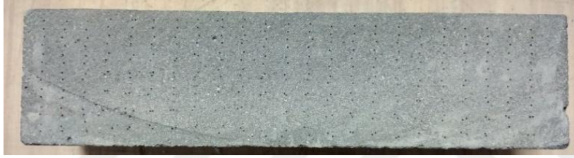
Şekil 3.130 : AR1-1-K numunesi, yüksek sıcaklık sonrası görünüm.
