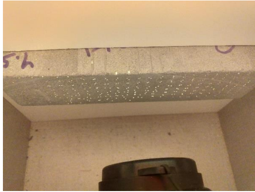
Şekil 3.89 : Numuneye uygulanan ışık geçirgenlik testi (AR1-1-K).
