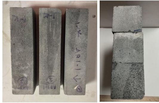
Şekil 3.113 : AR1-1-U numuneleri, ıslanma-kuruma çevrimleri sonrası görünüm.
