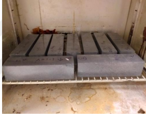
Şekil 3.80 : Etüvde kurumaya bırakılan AR1 grubu numuneleri.
