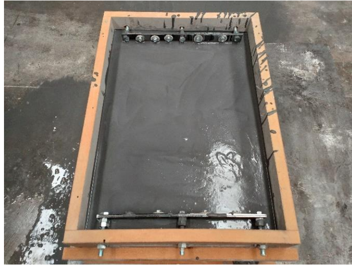
Şekil 3.23 : AR2 numune grubu, beton dökümü sonrası görünüm.
