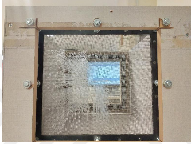
Şekil 3.18 : Optik fiberlerin örülmesi sırasında kalıpta bırakılan boşluklar.
