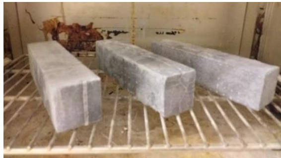
Şekil 3.98 : Etüvde kurumaya bırakılan PX grubu numuneleri.
