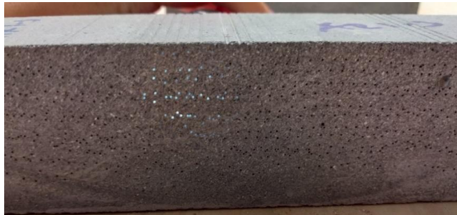
Şekil 3.132 : AR1-3-K numunesi, yüksek sıcaklık sonrası görünüm.
