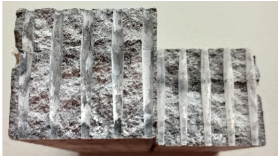
Şekil 3.143 : Islanma-kuruma çevrimleri sonrası test yapılan numunenin iç yüzeyine ait görünüm.
