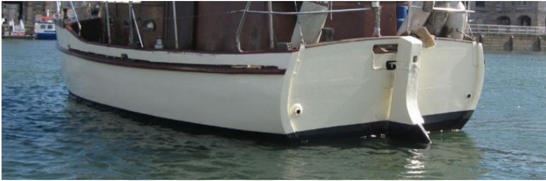
Şekil 5.28 : 1950 yapımı “Dauntless”. dümen palası aynaya dıştan takılmıştır.
