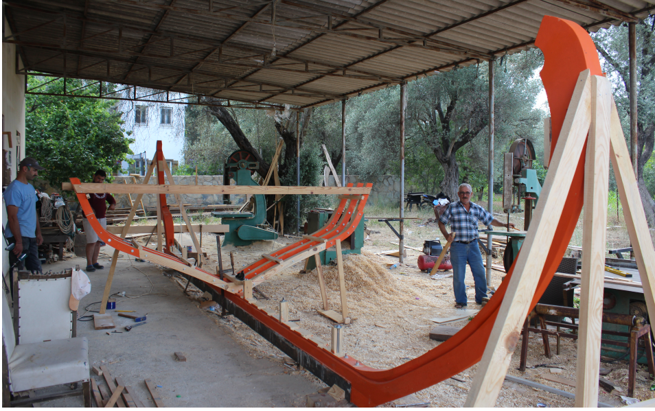
Şekil 5.15 : Yığma ahşap teknikle yapılan yelkenli tirhandil “Hızır”, 2017.
