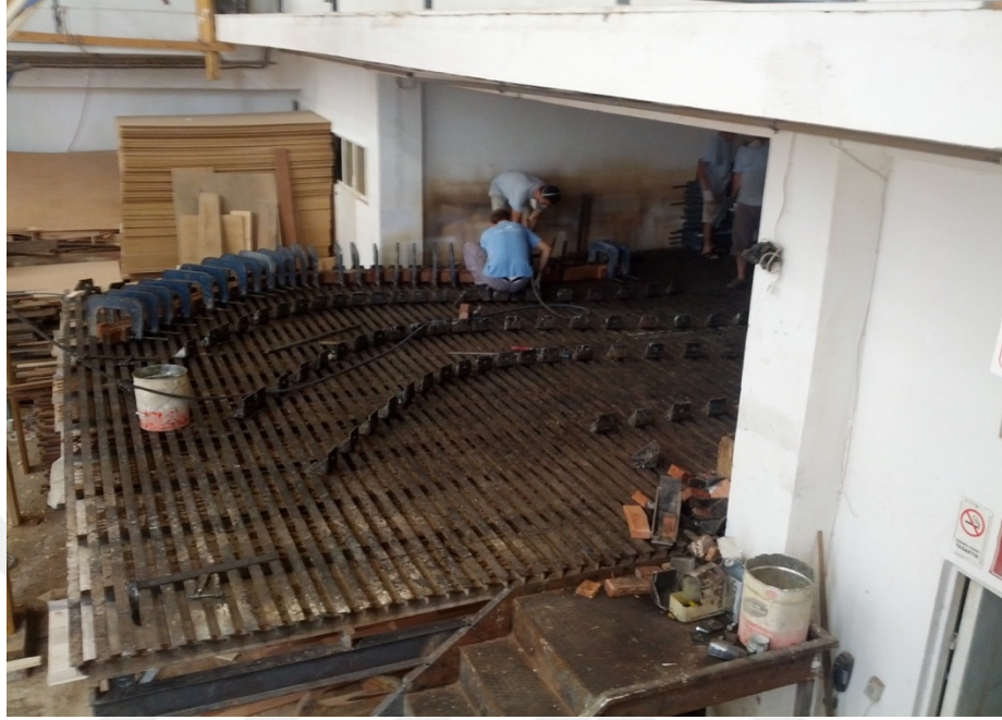
Şekil 5.19 : Izgara yapıda posta laminasyon tezgahı.
