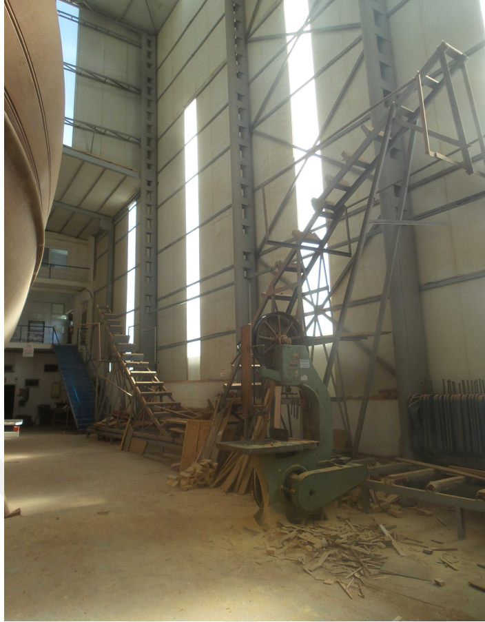
Şekil 5.20 : Mazlum Ağan'ın geliştirdiği parametrik omurga laminasyon tezgahı.
