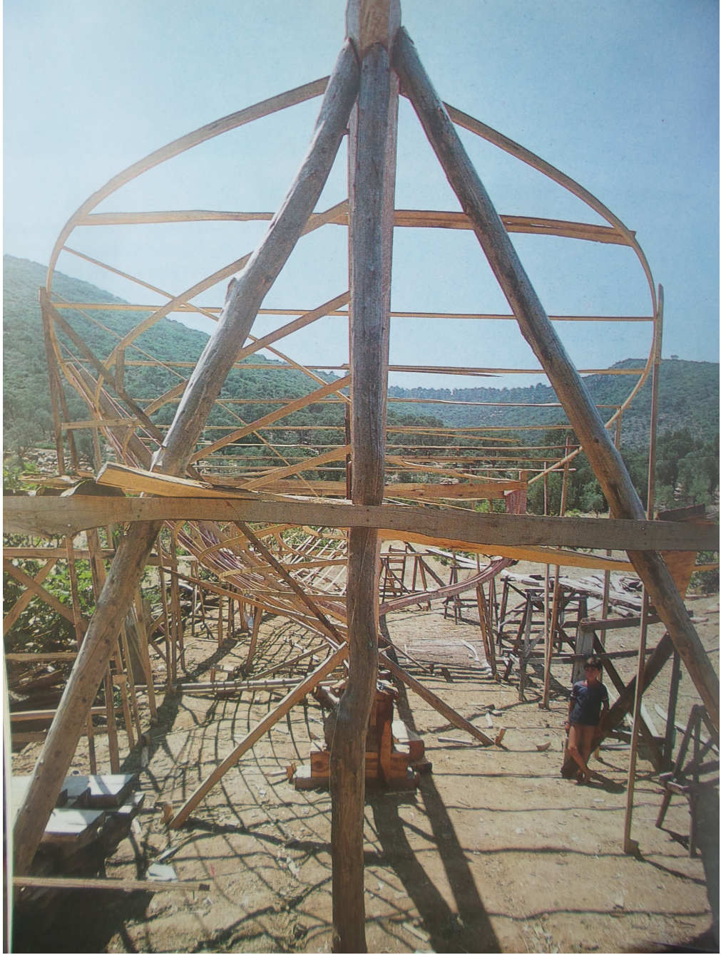
Şekil 5.18 : Aynakıç kurulumunda ince çıtalarla forma çekimi. Bodrum, 1987 (Fotoğraf: Prof. Dr. Önder Küçükerman).
