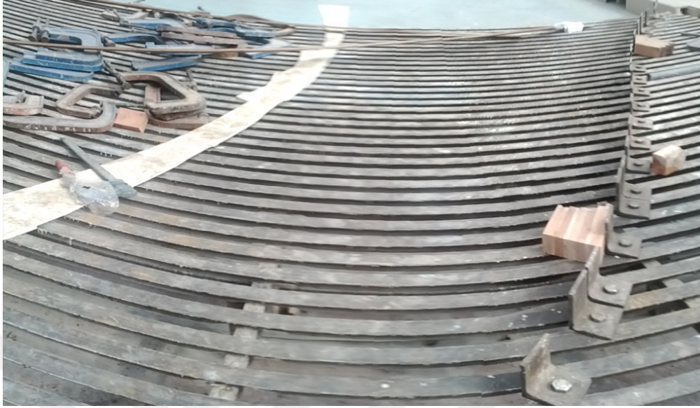
Şekil 5.21 : Laminasyon tezgahı üzerinde çelik kelepçeler (solda), kalıba göre sabitlenmiş çelik takozlar (sağda).
