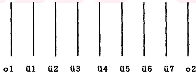
Şekil 5.2 Burada kullanılan interpolasyon algoritmasının üretilen kesitleri nasıl yerleştirdiği görülmektedir.(o : orijinal kesit , ü : üretilen kesit anlamındadır.)
