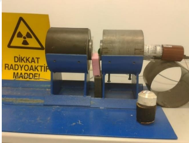
Şekil 3.2 : Gama transmisyon deney düzeneği.
