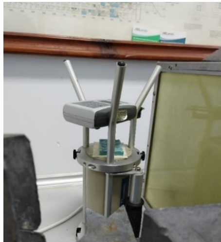
Şekil 3.4 : Beta transmisyon deney düzeneği.
