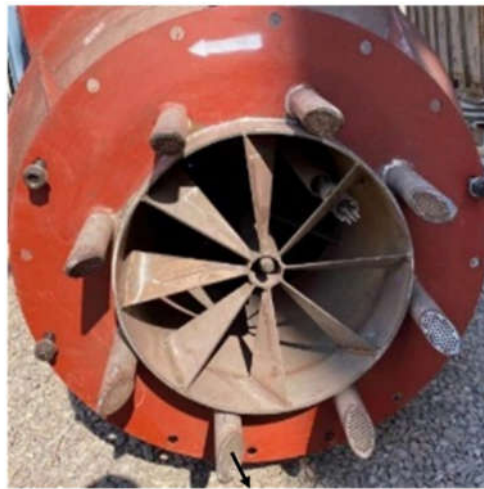
Şekil 2.2 : Sun ve arkadaşlarının çalışmasında kullanılan endüstriyel döngüsel yakıcıya ait görsel [23].
