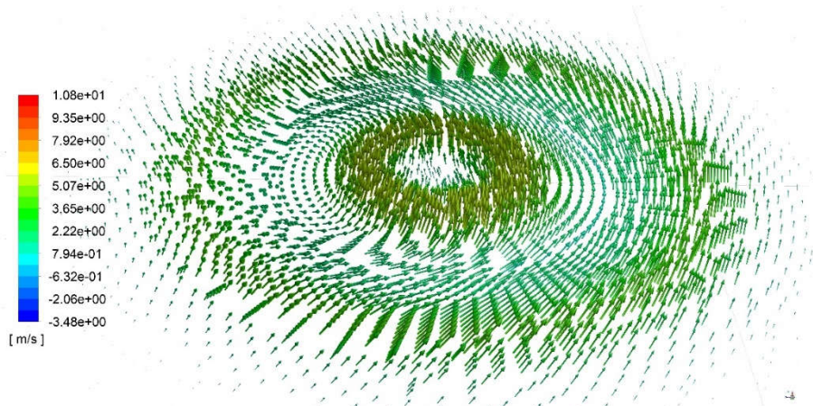
Şekil 4.65 : Yeni yakıcı geometrisinde gaz no 2'nin yakılması ile elde edilen akışın, yakıt girişinden 40mm ilerisindeki eksenel hız vektörleri.
