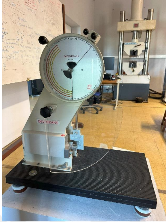
Şekil 2.2 : Çentik darbe deneyi düzeneği.
