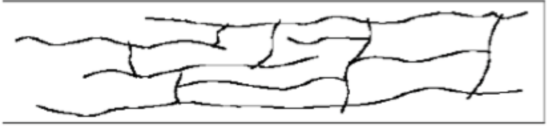
Şekil 2.5 : Termoset moleküllerin kür işlemi sırasında çapraz bağlanması [23]
