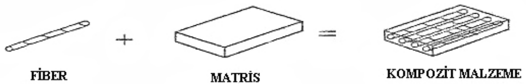
Şekil 2.1 : Kompozit malzemelerin ana elemanları
