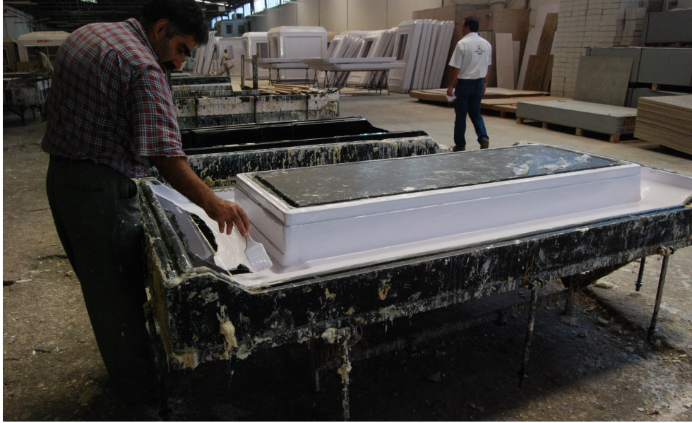
Şekil 5.11 : SAFTER MOBO’da el yatırma yönteminde jelkot uygulaması.
