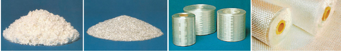
Şekil 4.3 : Cam takviye örnekleri: öğütülmüş, kırılmış, fitil ve dokuma (soldan sağa) [37].
