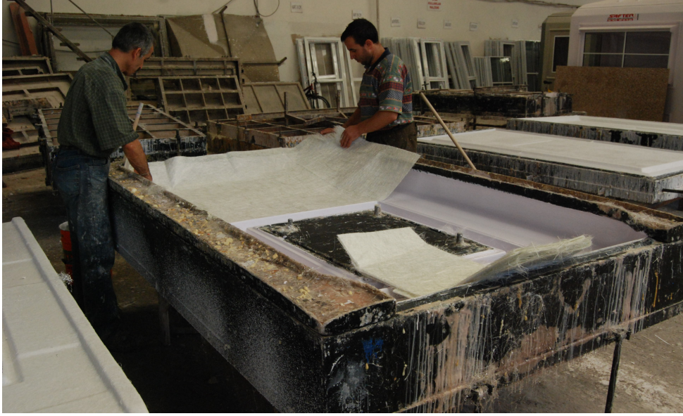
Şekil 5.8 : SAFTER MOBO firmasında el yatırma yöntemiyle kabin üretimi - 1
