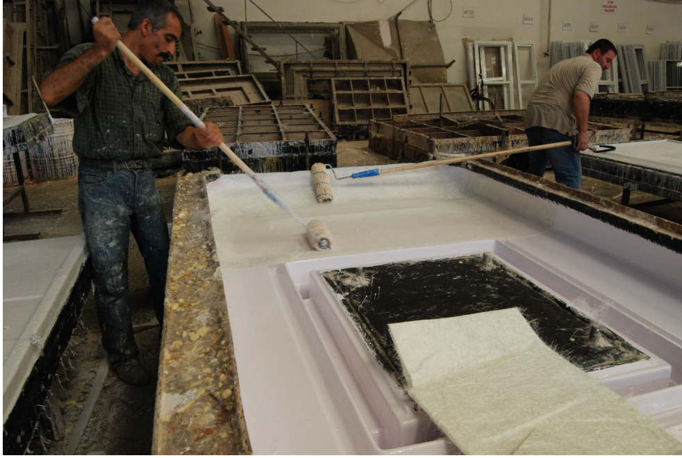
Şekil 5.9 : SAFTER MOBO firmasında el yatırma yöntemiyle kabin üretimi - 2
