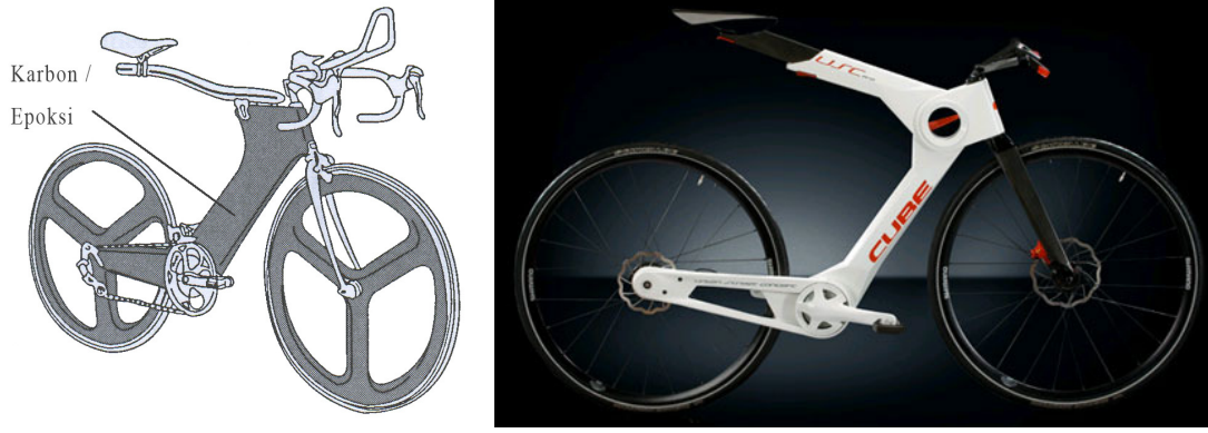
Şekil 4.2 : Karbonfiber takviyeli epoksi kompozitten üretilen bisiklet iskeleti [11].
