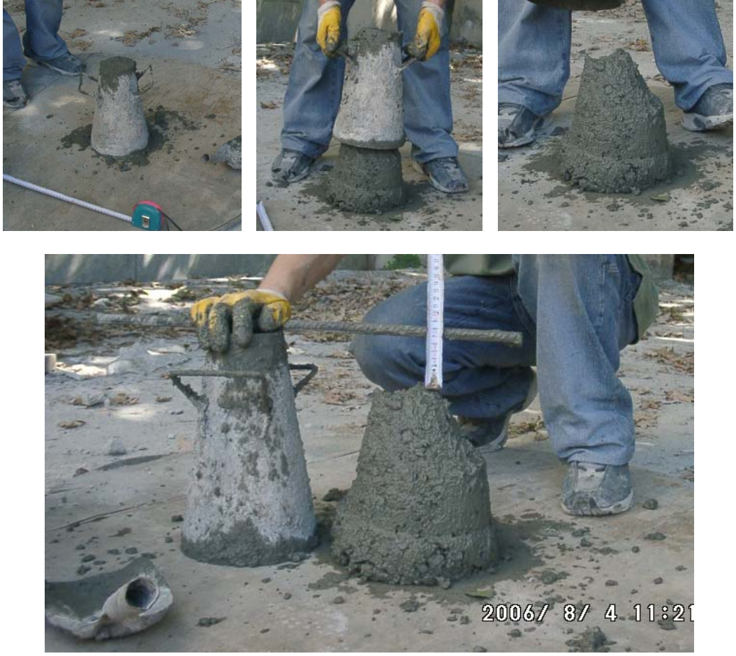
Şekil 3.6: Beton Çökme Deneyleri
