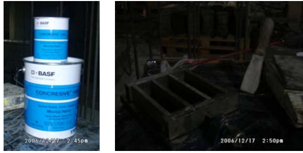
Şekil 3.14: Kullanılan Epoksi Bazlı Yapı Kimyasalı ve Numune Kalıpları
