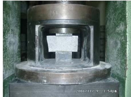
Şekil 3.16: Epoksi Esaslı Yapıştırıcının Basınç Dayanım Deneyi Düzeneği
