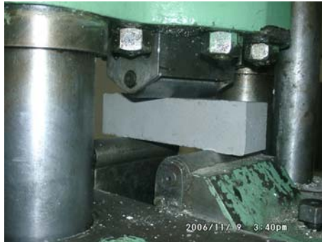
Şekil 3.15: Epoksi Esaslı Yapıştırıcının Çekme Dayanımının Belirlenmesine İlişkin Eğilme Deneyi Düzeneği
