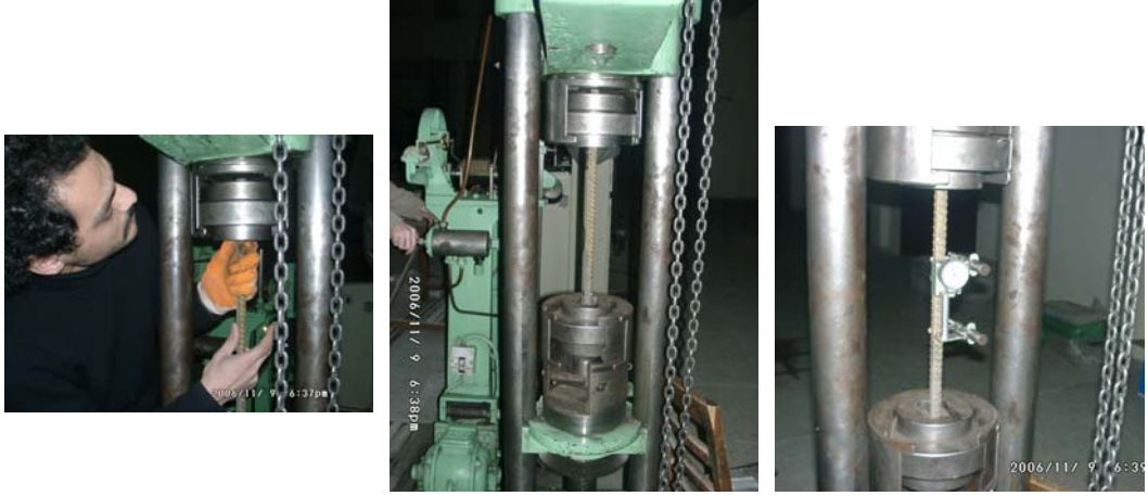
Şekil 3.10: Donatı Çekme Deneyi Düzeneyinin Hazırlanması
