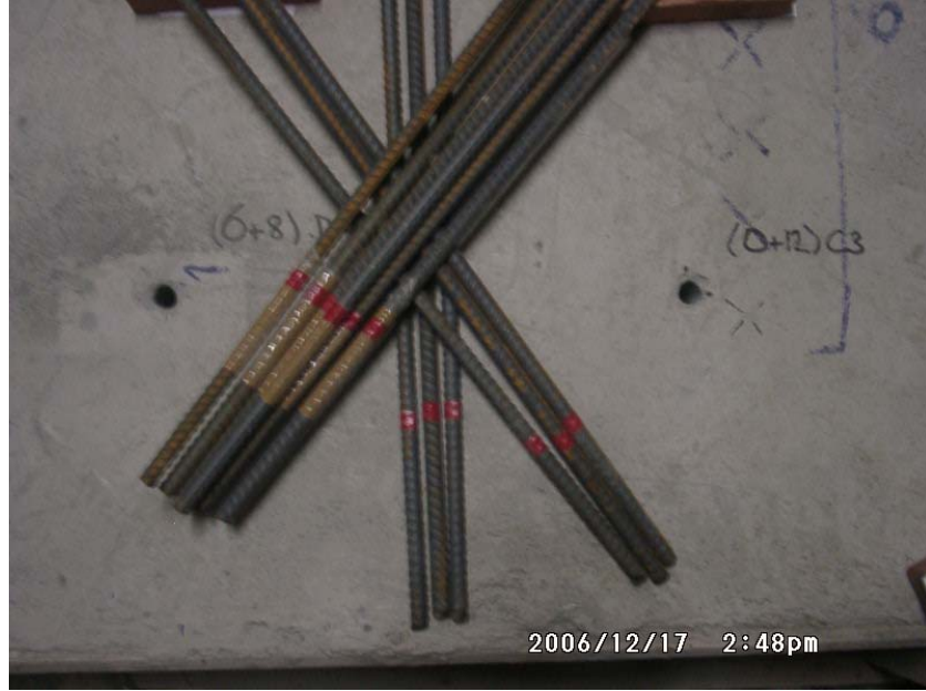
Şekil 4.7: Ankrajların Bağlı Derinliklerinin Hazırlanışı
