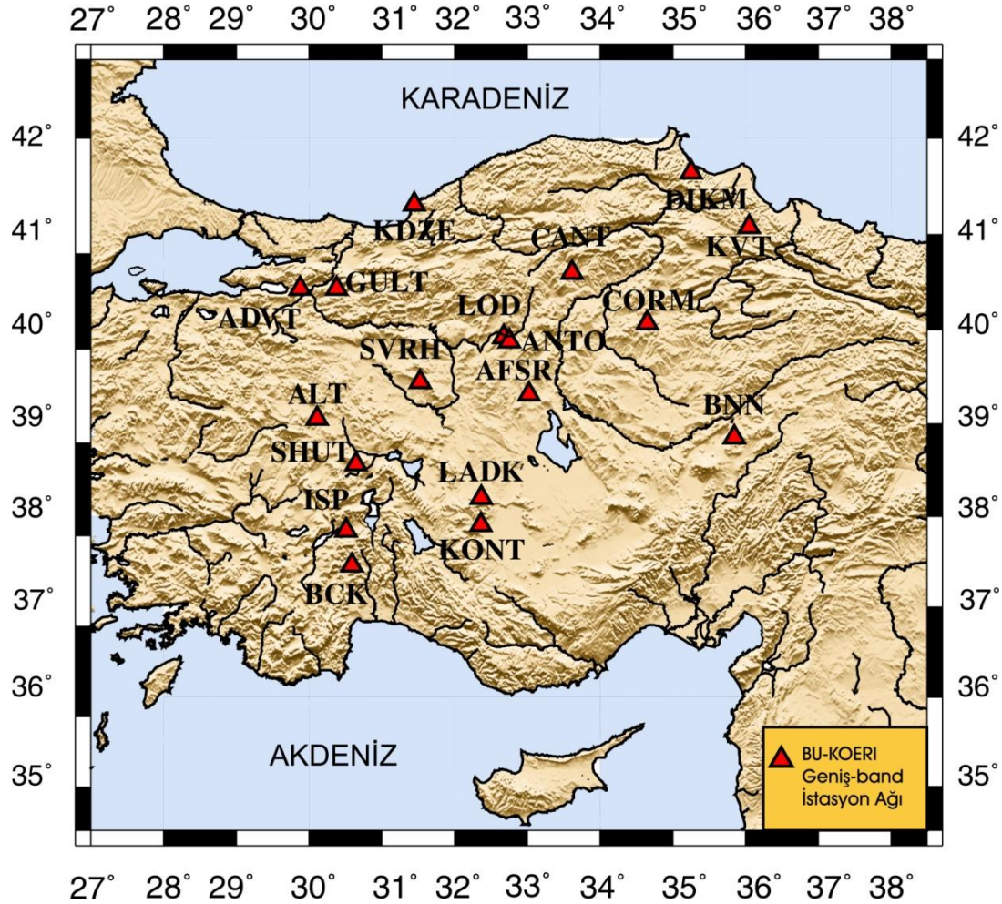
Şekil 3.1: Bâla-Sırapınar depremleri çözümünde kullanılan BU-KOERI-UDIM genişband istasyonların dağılım haritası (Çubuk ve Taymaz, 2009a, b).
