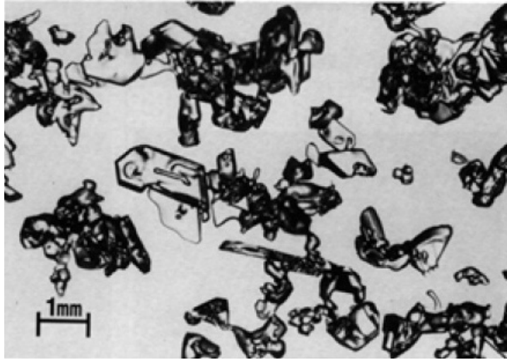
Şekil F.4: Sınıf 3mx, Düzlemsel yüzeyleri gelişen küresel partiküller (rounded particles with developing facets)
