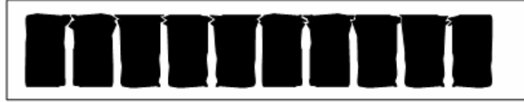
Şekil 2.16 : Asimetrik membranların yapısi.
