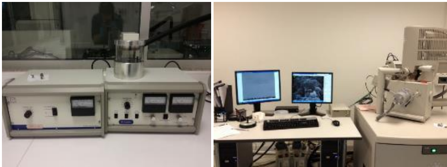
Şekil 3.9 : Ölçümlerde kullanılan Au-Pt kaplama ve SEM cihazı görüntüleri.
