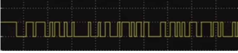
Şekil 2.6 : PRBS7 ile üretilmiş sinyal.
