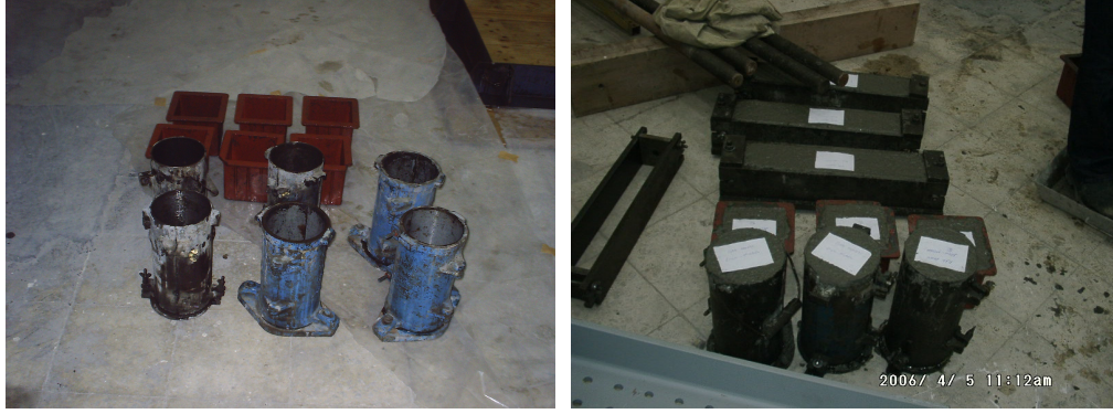
Şekil 4.14: Beton Dökümü Öncesi Mekanik Deneyler İçin Hazırlanan Kalıplar
