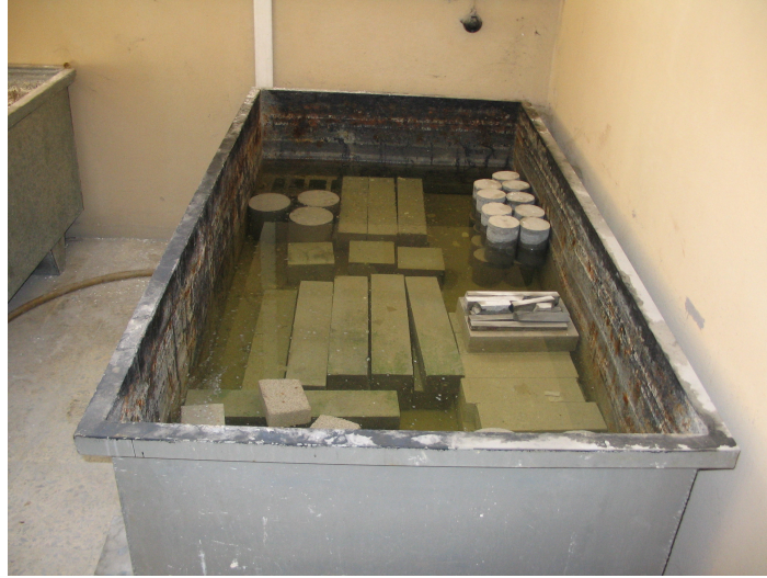
Şekil 4.15: Havuz İçerisindeki Sertleşmiş Beton Deneyi Numuneleri
