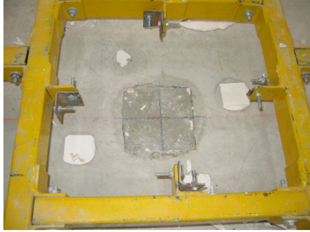
Şekil 6.13: P14 Plağı Yükleme Sonrası Orta Noktasının Görünümü
