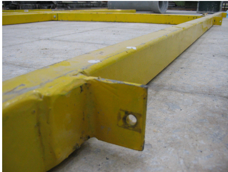
Şekil 4.7: Transducer Bağlantı Noktası Detayı
