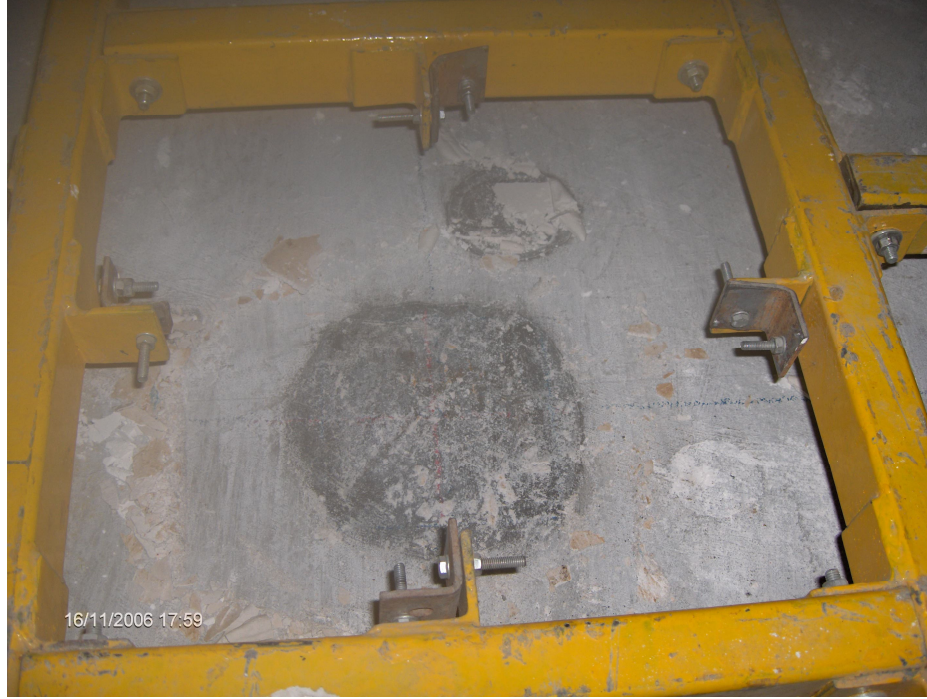
Şekil 6.8: P13 Plağı Yükleme Sonrası Orta Noktasının Görünümü
