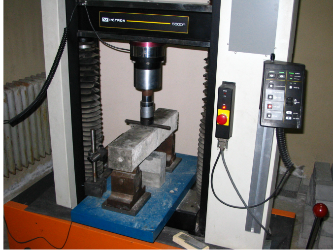
Şekil 4.18: Beton Kiriş Numunesinin Eğilme Dayanımı Deneyi
