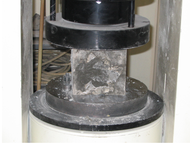
Şekil 4.16: Beton Küp Numunesinin Basınç Dayanımı Deneyi
