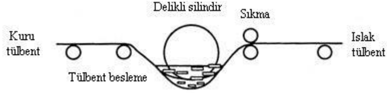
Şekil 2.30 : Sabitleştirilmiş Tülbentler İçin Emdirme
