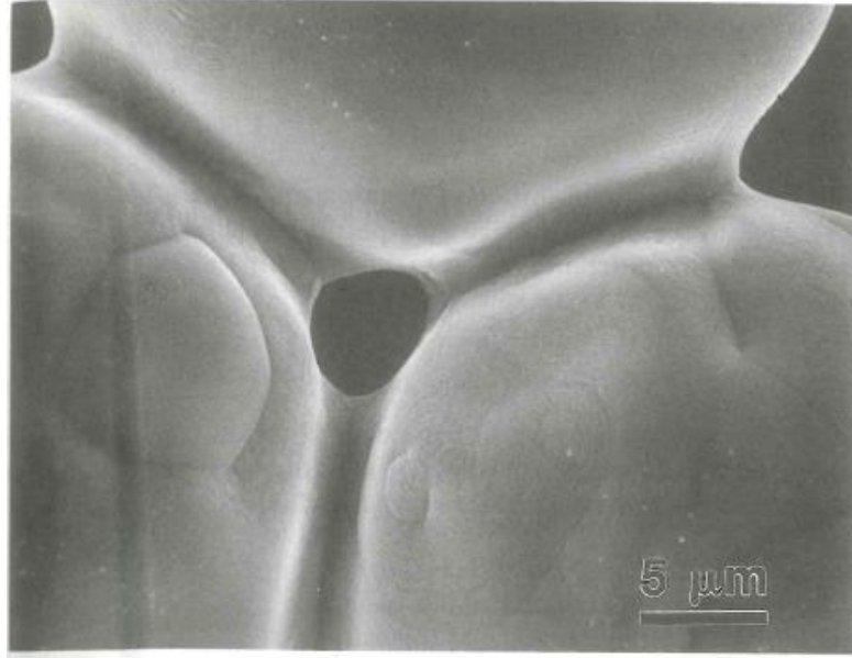
Şekil 3.2 : İki küresel partikülün temas noktasında oluşan sinter bağının taramalı elektron mikroskobu görüntüsü [41].
