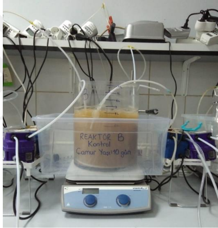
Şekil 5.1 : Çamur yaşı 10 günde işletilen kontrol reaktörü
