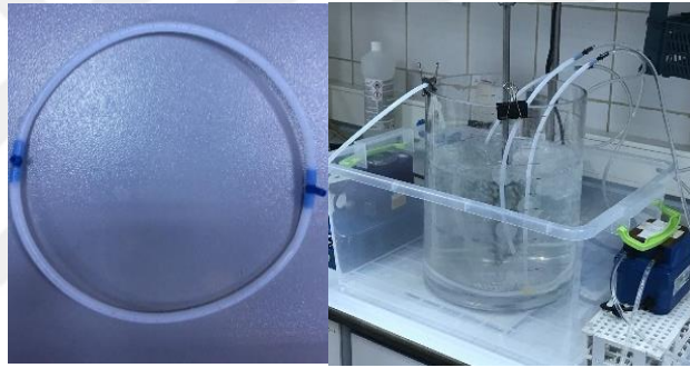
Şekil 4.2 : Teflon malzemeden yapılmış havalandırma boruları
