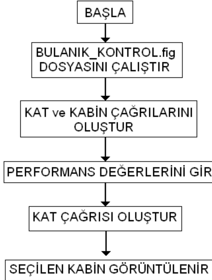
Şekil 5.22 Kontrol programı akış diyagramı
