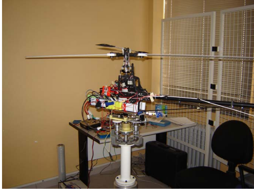
Şekil 2.22 : Model helikopter kontrolcüsü test platformu.
