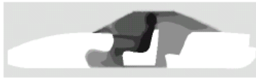
Şekil 4.3 : Dış sıcaklık düşük olduğu zaman taşıt içerisinde oluşan sabit sıcaklık
