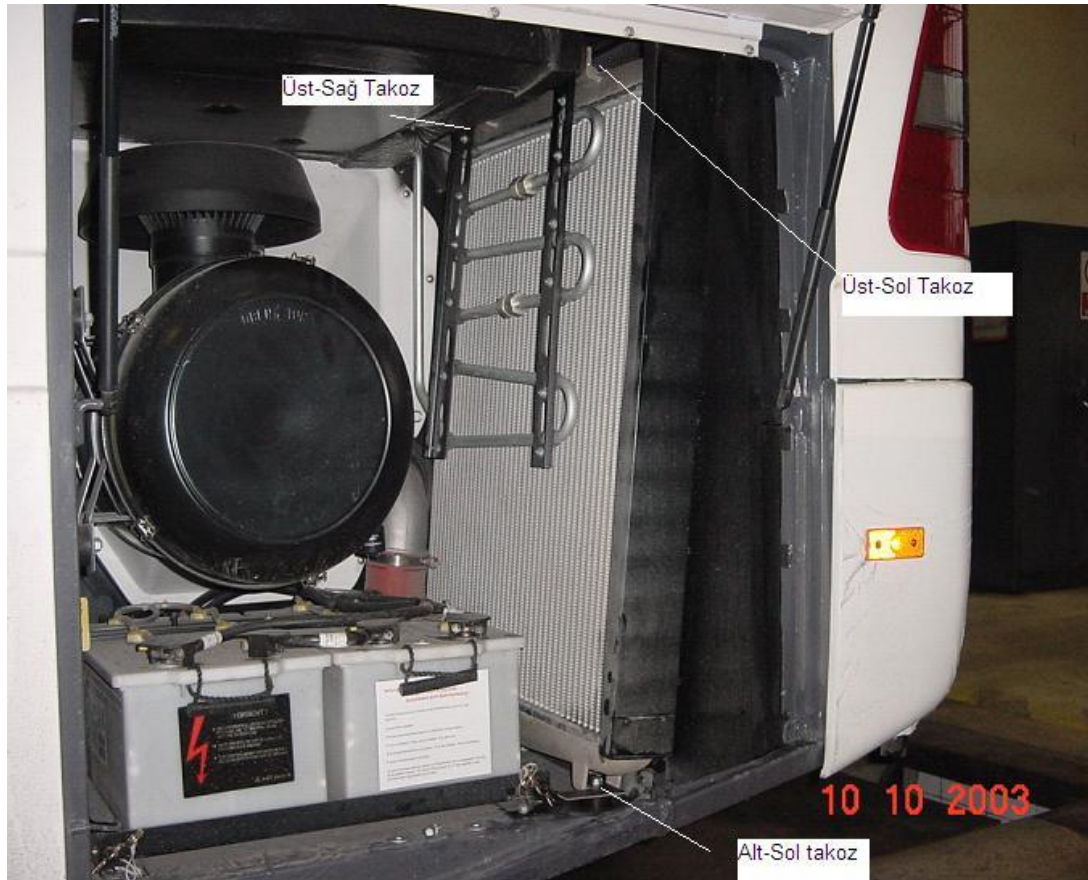
Şekil 5.1: Hava radyatörü ve taşıt içindeki konumu
