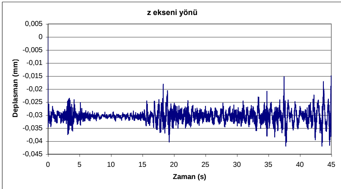
Şekil 5.14: Lastik takozların z eksen yönündeki sehimleri
