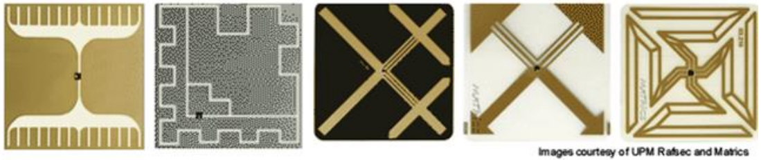
Şekil 5.4: RFID Etiket Antenlerinin Yapısı (Deb Navas, 2004)
