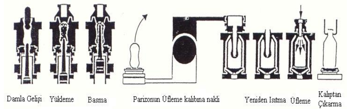
Şekil 4.9: Dar ağzlı cam ambalajın pres – üfleme prosesiyle şekillendirilmesi [22].
