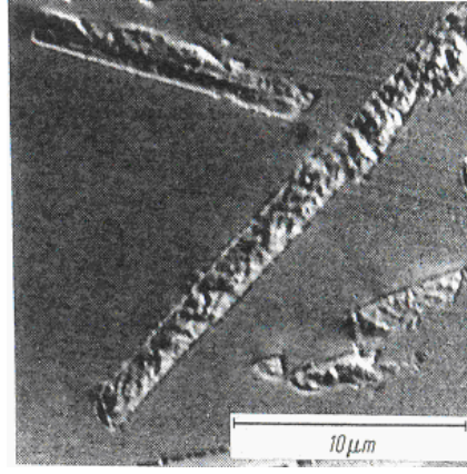
Şekil 4.12. Uzun süre ısıtılmış camdaki Na-phlogopite kristalleri [2]
