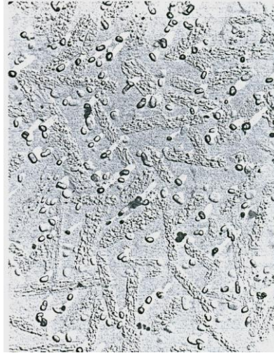
Şekil 3.8. Çok bileşenli lityum-silikat camında oluşan lityum disilikat kristalleri [15].
