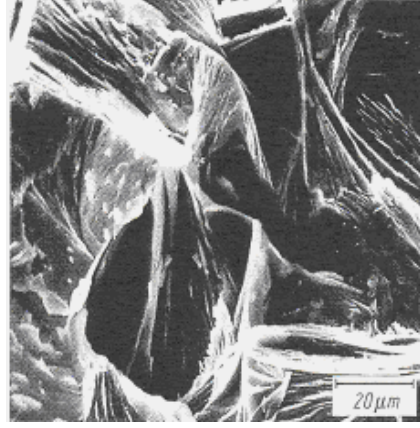
Şekil 4.8. \text{Na}_2\text{O-MgO-Al}_2\text{O}_3\text{-SiO}_2\text{-F} ana cam fazında oluşan büyük sodyum phlogopite kristalleri [2].
