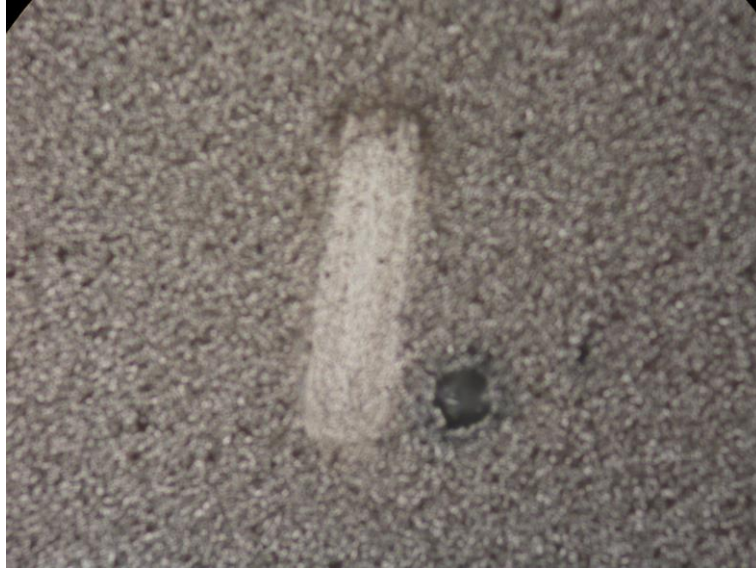
Şekil 6.19. 1400 0 C’de sinterlenmiş numunedeki aşınma izi (X50 büyütme)
