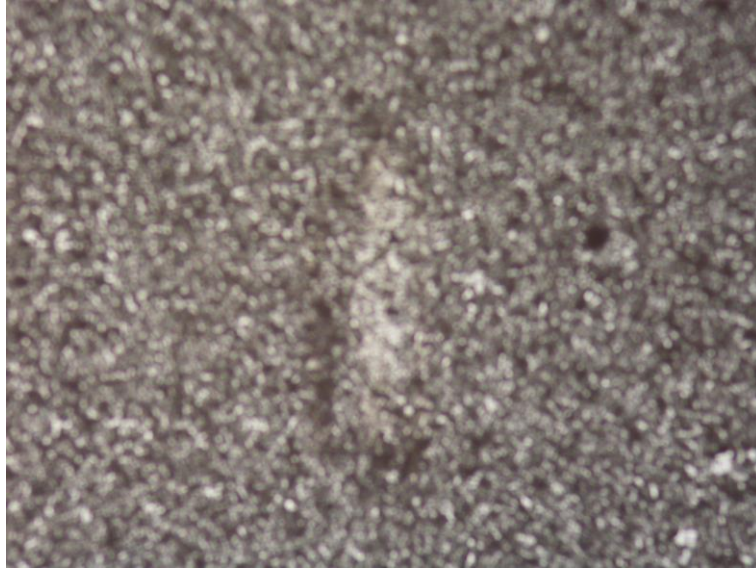
Şekil 6.21. 1500 0 C’de sinterlenmiş numunedeki aşınma izi (X50 büyütme)
