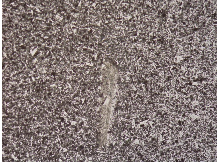
Şekil 6.22. 1550 0 C’de sinterlenmiş numunedeki aşınma izi (X50 büyütme)
