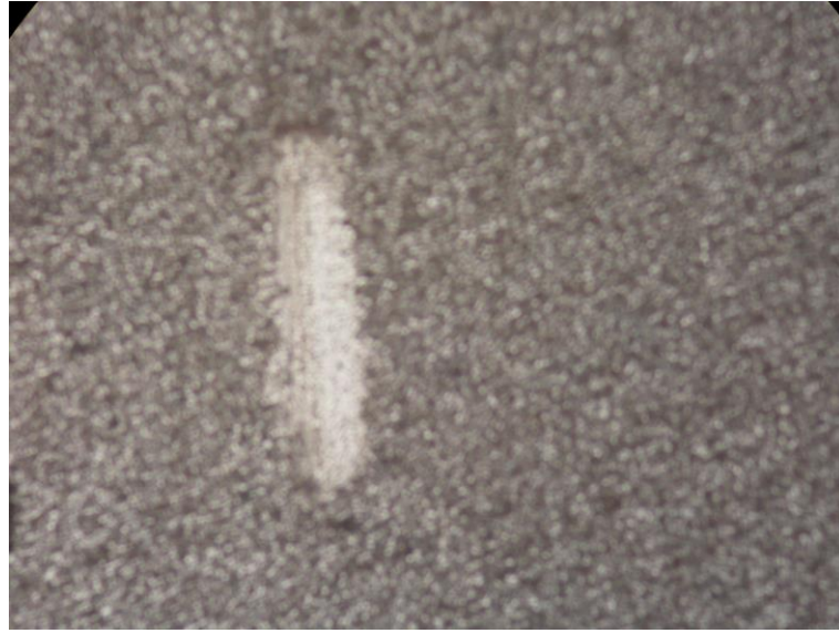
Şekil 6.17. 1300 °C’de sinterlenmiş numunedeki aşınma izi
