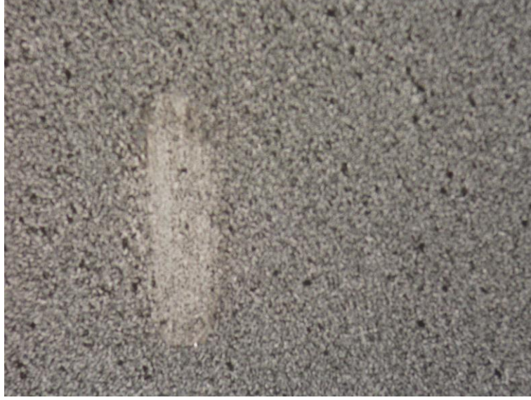
Şekil 6.18. 1350 0 C’de sinterlenmiş numunedeki aşınma izi (X50 büyütme)
