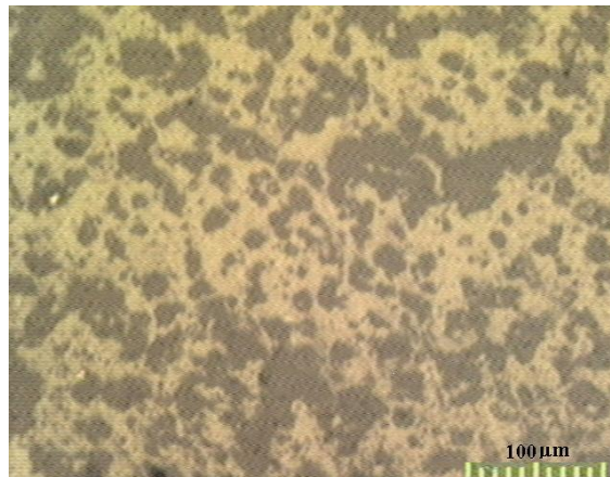
Şekil 6.23. Doğal hammaddelerden hazırlanmış ve 1350 °C'de 3 saat sinterlenmiş D1 numunesinin optik mikroskop görüntüsü (X160 büyütme)
