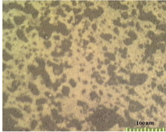
Şekil 6.22. Doğal hammaddelerden hazırlanmış ve 1350 °C'de 1 saat sinterlenmiş D1 numunesinin optik mikroskop görüntüsü (X160 büyütme)
