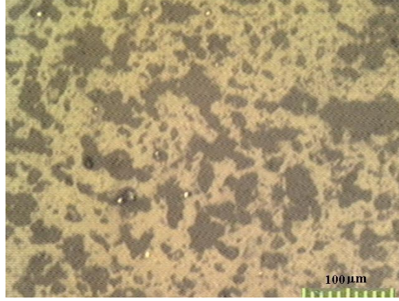
Şekil 6.27. Doğal hammaddelerden hazırlanmış ve 1350 °C’de 3 saat sinterlenmiş D2 numunesinin optik mikroskop görüntüsü (X160 büyütme)
