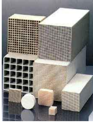
Şekil 4.8. Şekillendirilmiş kordiyerit bal peteği yapıları [18]
