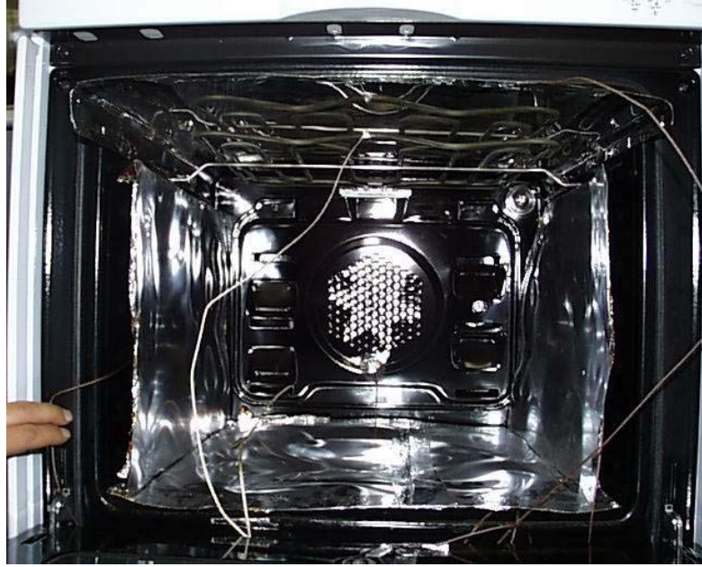
Şekil 3.3.4 Fırın iç duvarlarında yansıtıcı
