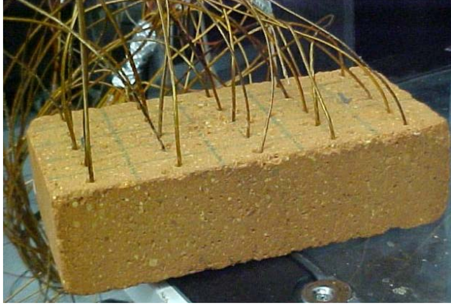
Şekil 3.7.1 Yükseklik merkezinde 25 noktadan delinmiş tuğla
