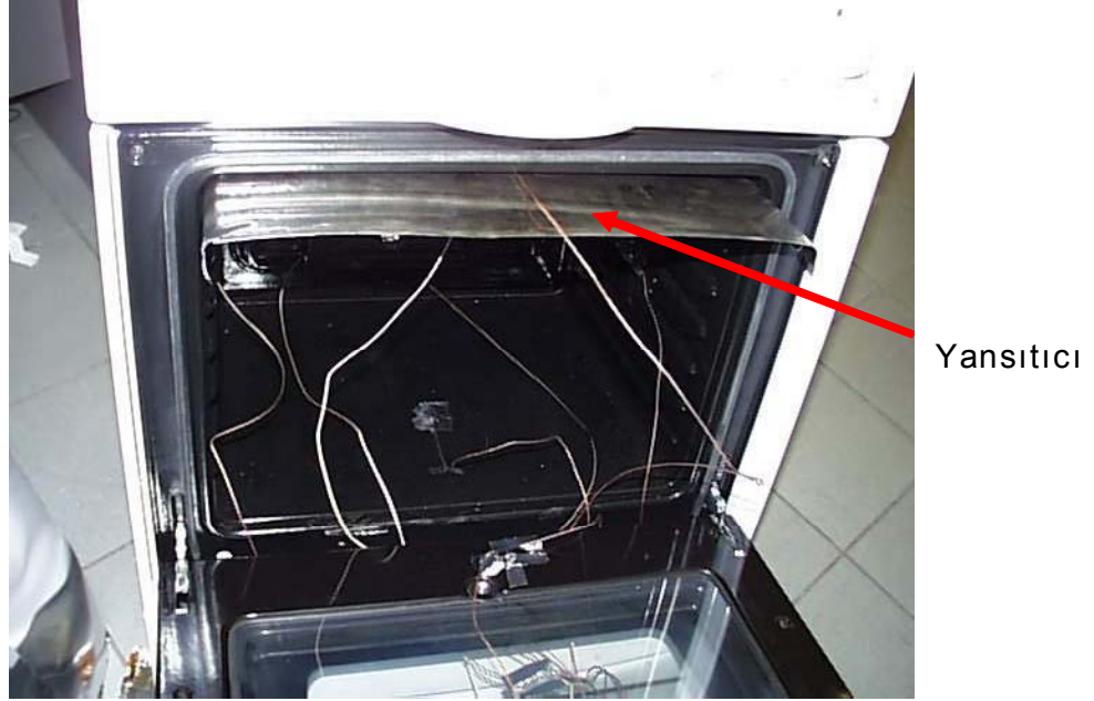
Şekil 3.3.3 Isıtıcı üzeri yansıtıcı
