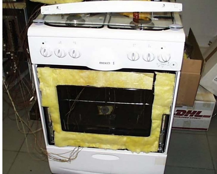
Şekil 3.5.2 Kapak çerçevesinin izole edilmesi
