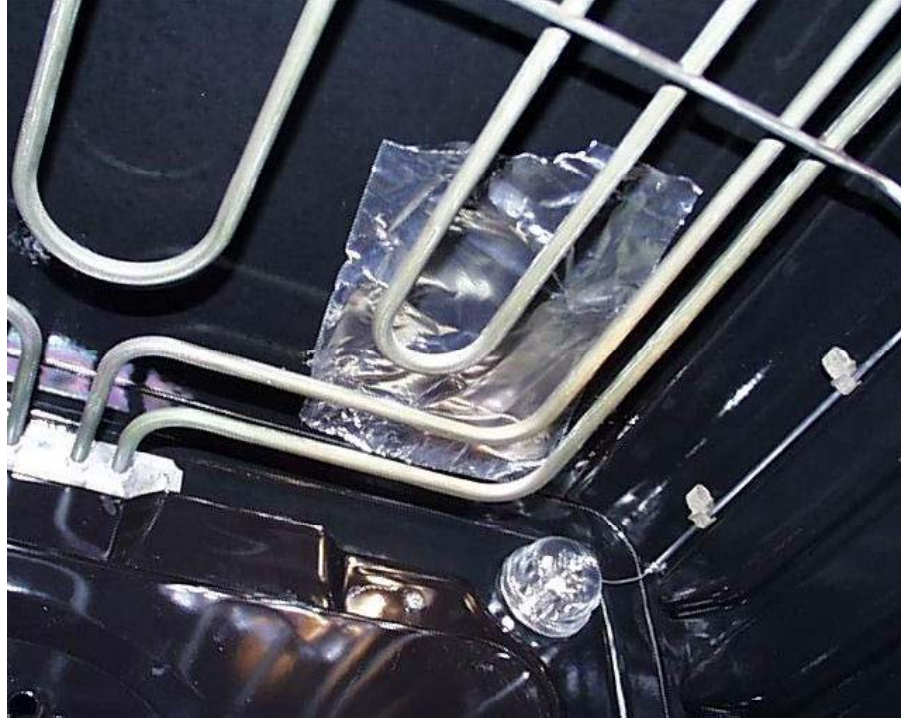
Şekil 3.3.2 Fırın baca çıkışının kapatılması
