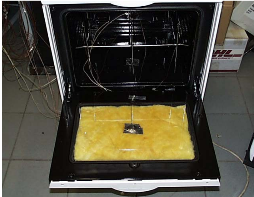
Şekil 3.3.5 Fırın kapağının tamamen izole edilmesi
