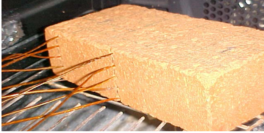
Şekil 3.7.4 Derinlik merkezinde yükseklik boyunca 10 noktadan delinmiş tuğla
