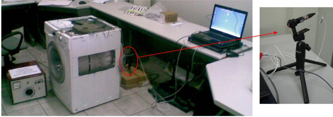
Şekil 5.25: Ucuz takonun denenmesi için hazırlanan ölçüm düzeni
