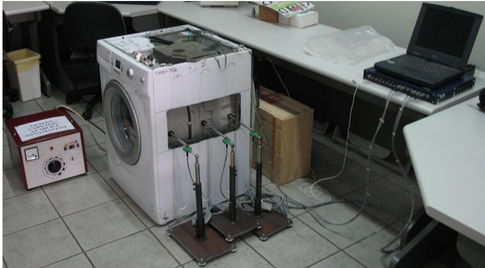
Şekil 5.9: Z eksenı boyunca dengesizliğin belirlenebilmesi için hazırlanan ölçüm düzeneđi
