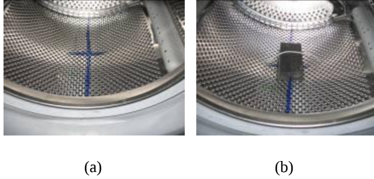
Şekil 3.15: Dengesiz kütlelerin montaj şekli ve pozisyonu
