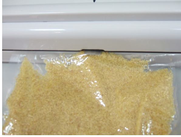
Şekil 3.4: Packtech Markalı Vakum Makinasında İnce Taneli Gıdaların Vakumlanması
