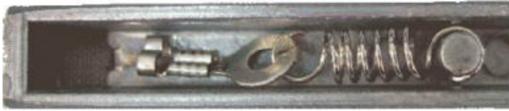
Şekil 2.33: Yassı Kesitli Rezistans Telinin Kullanıldığı Isıtıcı Grubunda Yay Bağlantısı
