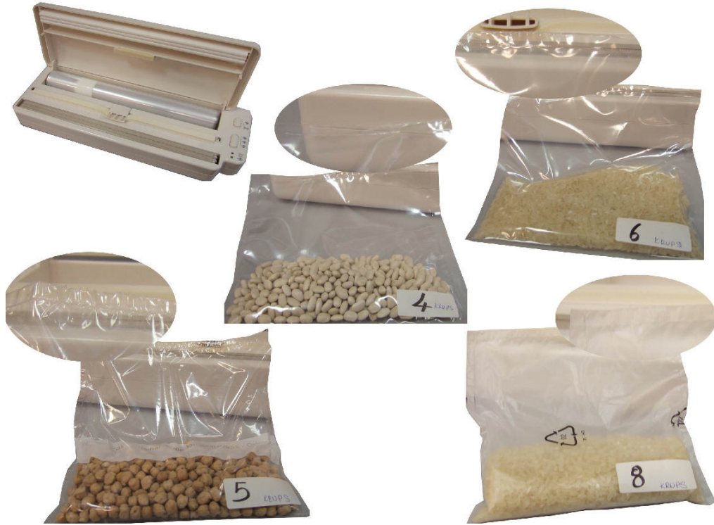
Şekil 3.1: Krups Marka Düz Poşet Vakumlayan Vakum Makinasının Düz Poşet/Rulolardaki Performansı
