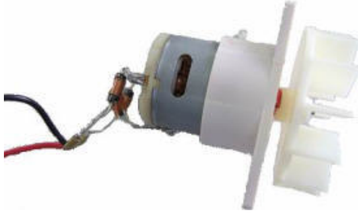
Şekil 2.21: Fan Tipi Pompanın Gösterimi
