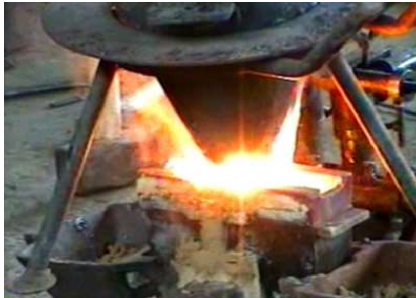
Şekil 3.29 Erişmiş metalin kaynak boşluğuna dökümü
