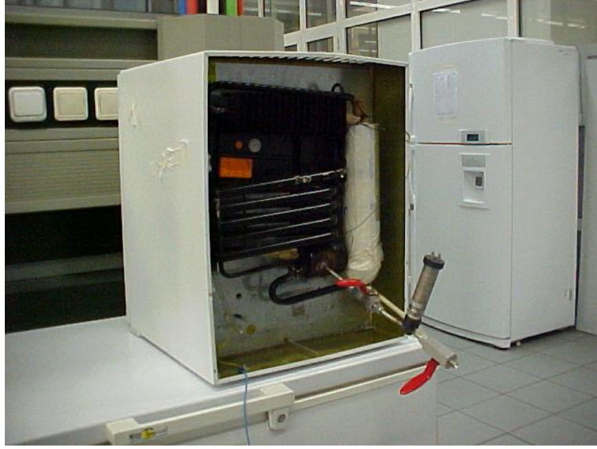
Şekil 3.1 Şarj işlemi sonrasında deneye hazır hale getirilen sistem
