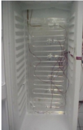
Şekil 6.3. Soğuk tarafa uygulanan termosifon sisteminin buharlaştırıcı kısmı.
