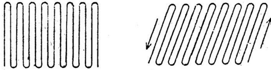
Şekil 3.10 Kısmikristalin plastiklerde kristalin zincirlerin kayması [2]
