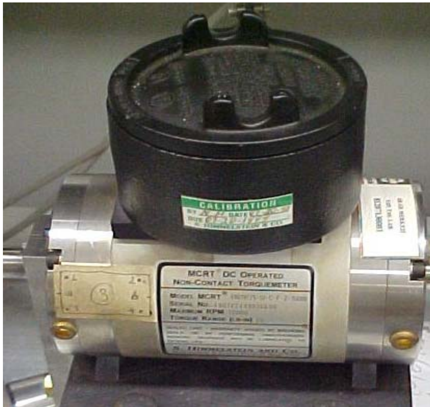
Şekil 3.8 Himmel Stein'in 4901V torkmetresi
