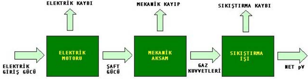
Şekil 1.3 Kompresörde enerji dönüşümü.
