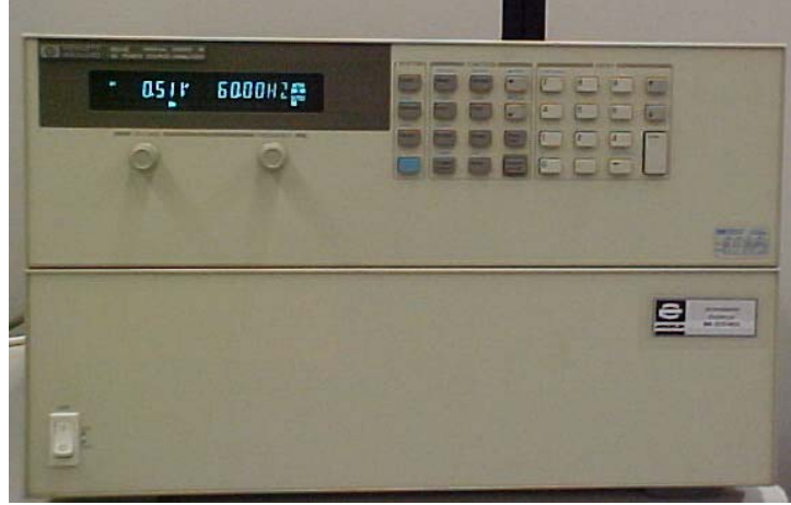
Şekil 3.6 Hewlett Packard® 6814B serisinden bir alternatif akım kaynağı.
