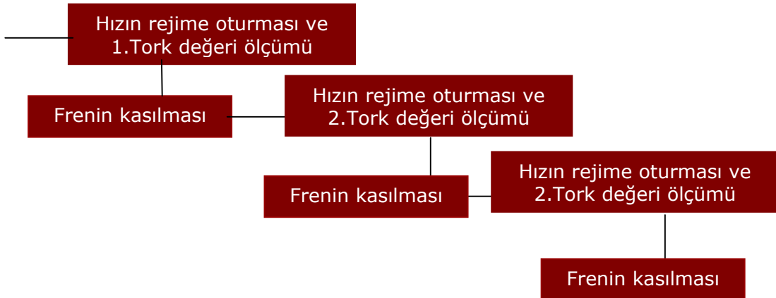
Şekil 3.14 Deney sisteminin ölçme tekniği
