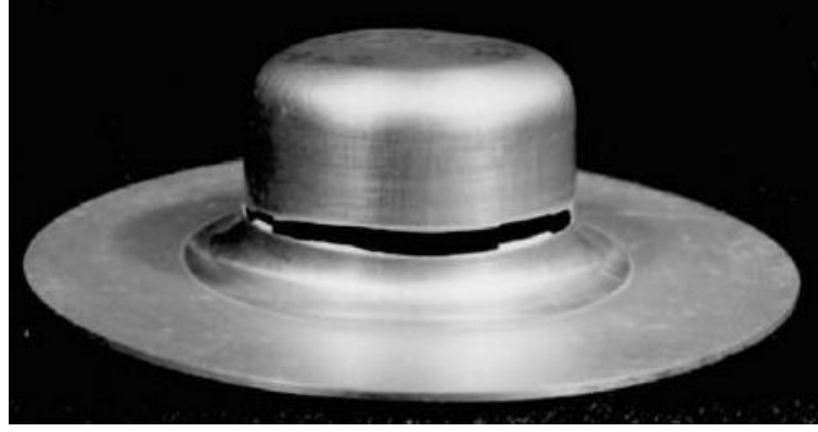
Şekil 4.17. Ilık derin çekme deneyinde hasar ( DR=2.8 ve r_d=7.5 mm) [Takuda vd., 2002].
