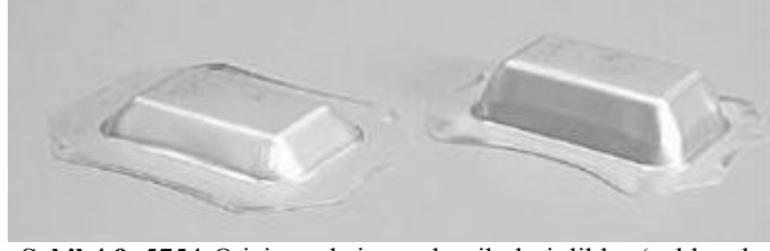
Şekil 4.9. 5754-O için maksimum konik derinlikler (solda oda sıcaklığında ve sağda 250 °C sıcaklıkta) [Bolt vd., 2001].
