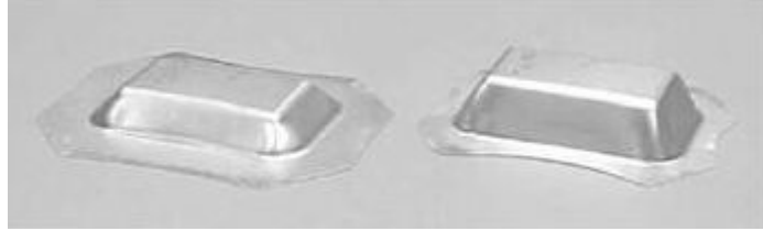
Şekil 4.10. 6016-T4-O için maksimum konik derinlikler (solda oda sıcaklığında ve sağda 175 °C sıcaklıkta) [Bolt vd., 2001].
