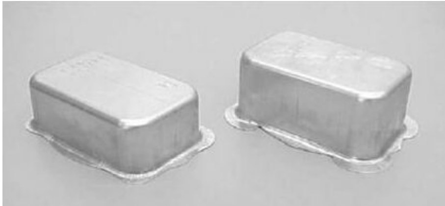
Şekil 4.7. 1050-H14 için maksimum ürün yükseklikleri (solda oda sıcaklığında 80 mm ve sağda 175 °C sıcaklıkta 100 mm) [Bolt vd., 2001].
