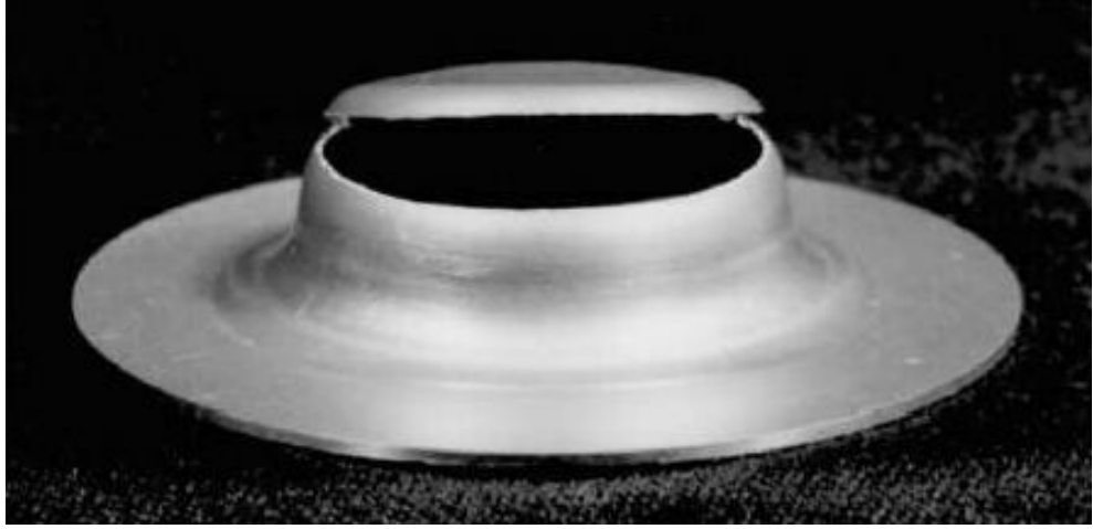
Şekil 4.13. Oda sıcaklığında derin çekme deneyinde hasar (DR=2.4 ve r_d=7.5 mm) [Takuda vd., 2002].
