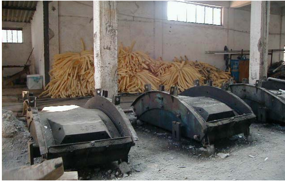
Şekil 8.3 Segment atölyesi ve titreşimli segment kalıpları
