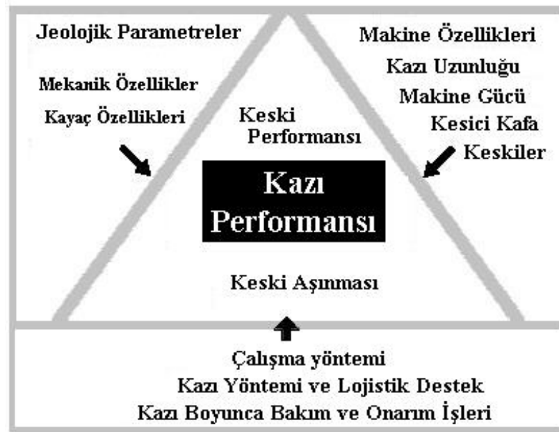
Şekil 2.7 Kollu makine uygulamasında kazı performansını etkileyen parametreler [8]
