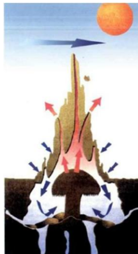
Şekil 3.11 : Termit yuvası havalandırma sistemi.
