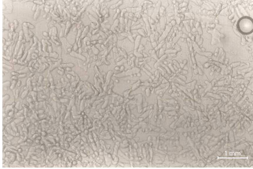
Şekil 5.32 : Serbest düşme-cam deneyinde damla toplama yüzeyine çarptıktan sonra damlanın orta kısmındaki kırılmış dendrit kolları.
