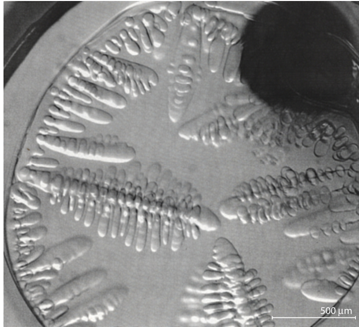
Şekil 5.29 : Deformasyon öncesinde hızlı katılaştırılmış damla.
