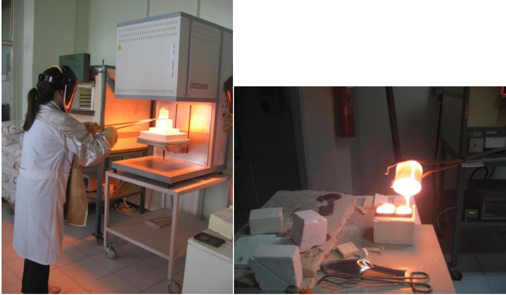
Şekil 6.12 : Asansörlü cam fırınında cam eritme ve grafit kalıba cam dökümü.
