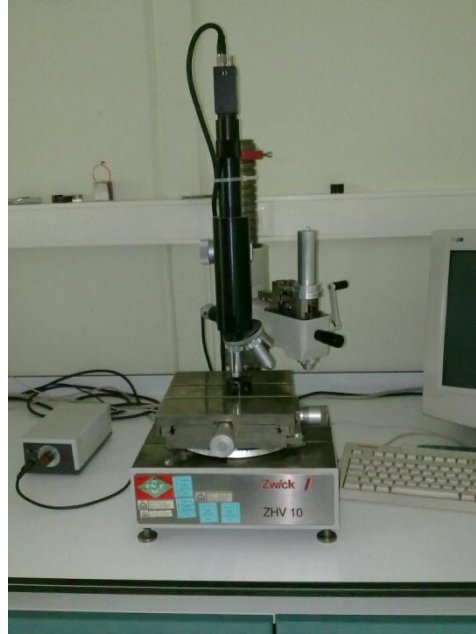
Şekil 6.7 : Zwick marka ZHV10 model mikrosertlik cihazı.
