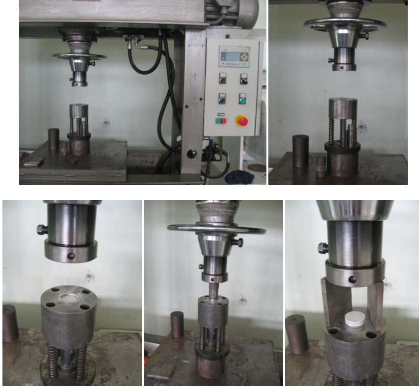
Şekil 6.4 : Presleme aşamaları ve silindirik numune eldesi.
