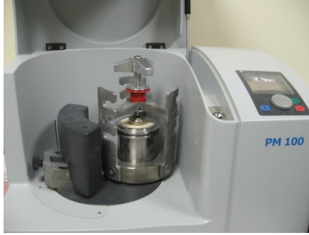
Şekil 6.1 : RETSCH marka PM100 model bilyalı kuru öğütme cihazı.
