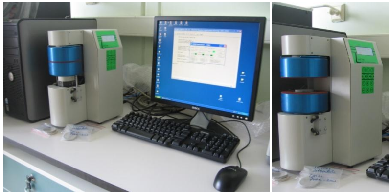
Şekil 6.10 : Flash Line FOX50 ısı iletkenlik cihazı.
