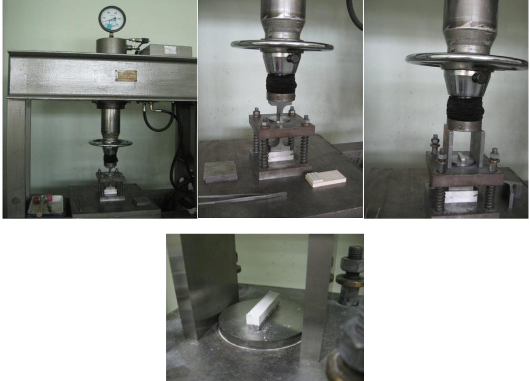
Şekil 6.3 : Presleme aşamaları ve çubuk numune eldesi.
