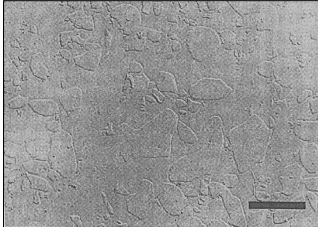
Şekil 5.3 : % 20 alümina içeren cam/alümina kompozit.
