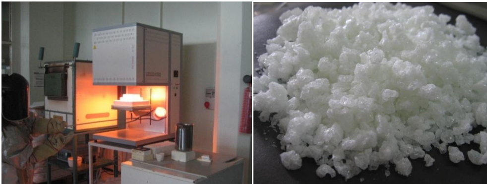
Şekil 6.16 : Cam eriyiğın suya dökümü ve elde edilen CMS1 kodlu fritin görünümü.
