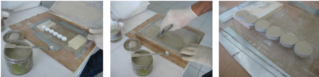
Şekil 7.73 : Ag pasta uygulama aşamaları.
