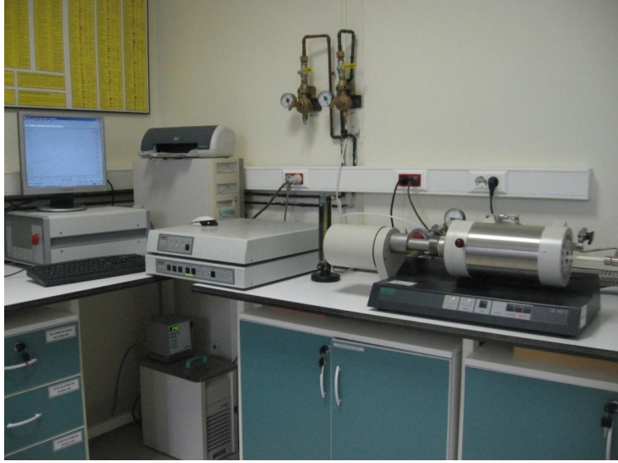
Şekil 6.8 : Dilatometre ısı genleşme ölçüm cihazı.
