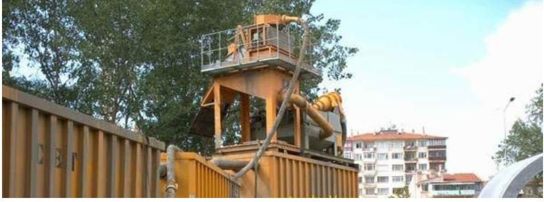
Şekil 3.20 : Kazılan malzemenin ince ve iri boyutlara ayrıldığı separatör.
