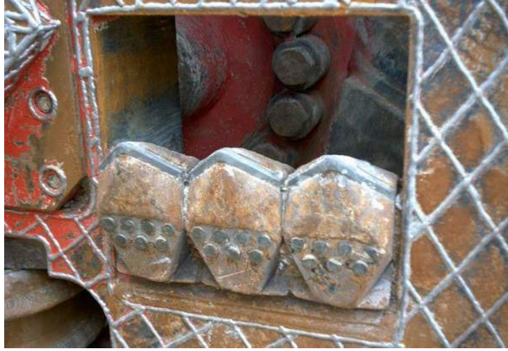
Şekil 2.11 : Aynadaki kazı alanını genişleten kazma keskiler.
