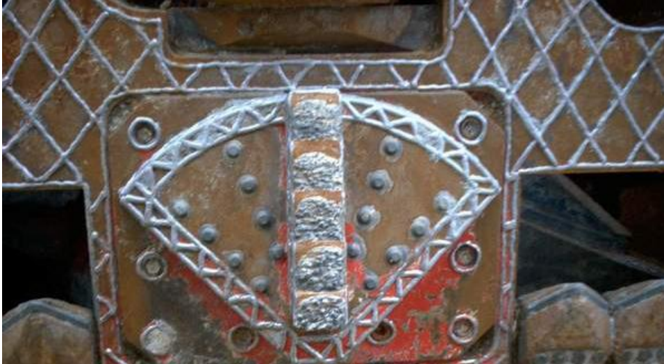
Şekil 2.9 : Mikrotünel açma makinesinin önünde bulunan merkezleyici keski.
