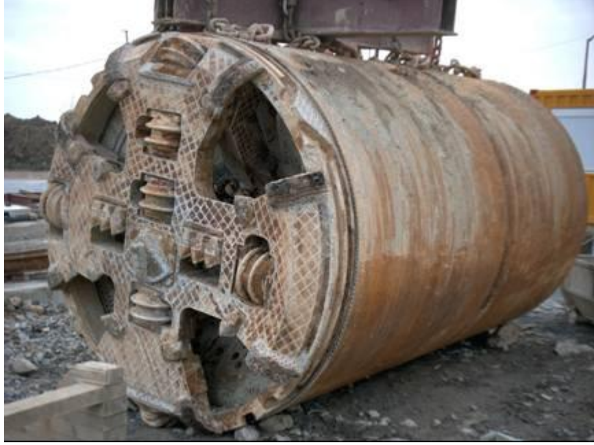
Şekil 3.15 : Temizleme ve bakım işleri bittikten sonra kuyuya indirilecek mikrotünel makinesi.
