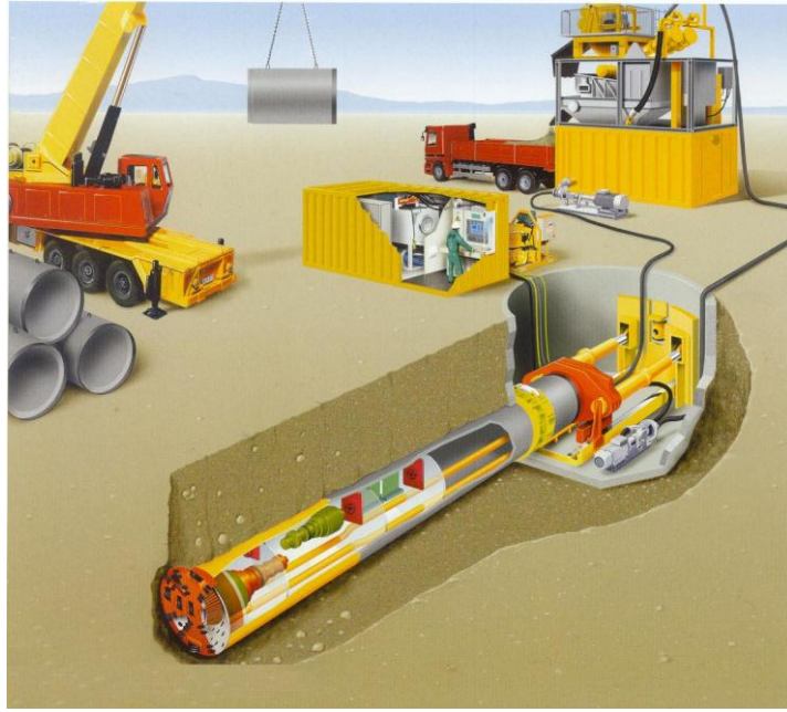
Şekil 2.6 : Başarılı bir boru itme uygulaması [19] .
