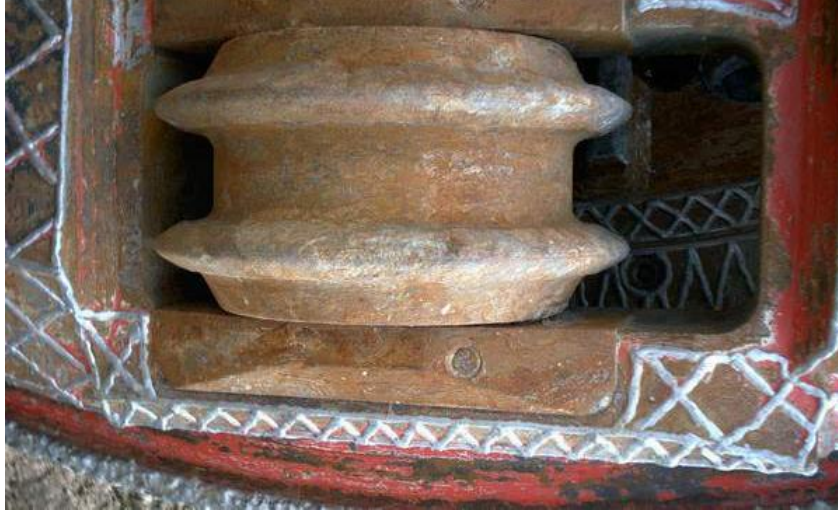
Şekil 2.10 : Sert ve orta-sert malzeme kesimini yapan disk keski.
