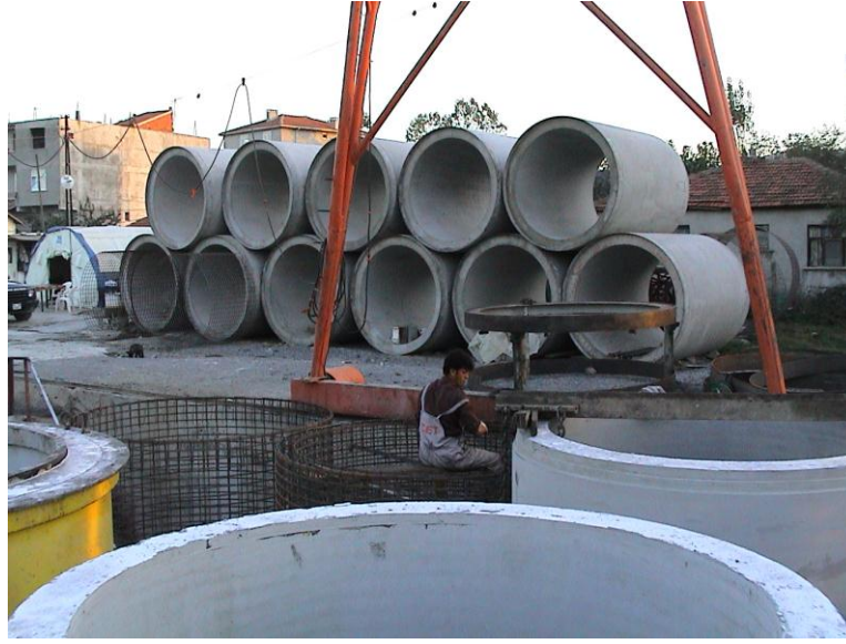
Şekil 3.23 : İmal edilen boruların stoklanması.
