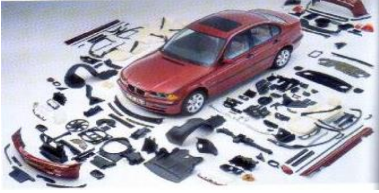
Şekil 8.14 Bir BMW otomobilinde kullanılan plastik elemanlar [55]
