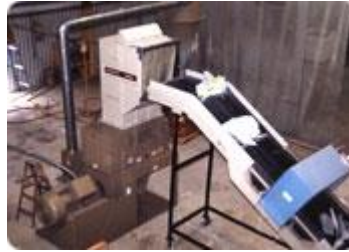
Küçük boyutlu plastik torbaların kesilmesi
