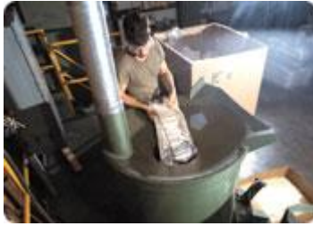
Malzemelerin geri dönüşüm için kırma makinesinden geçirilmesi
