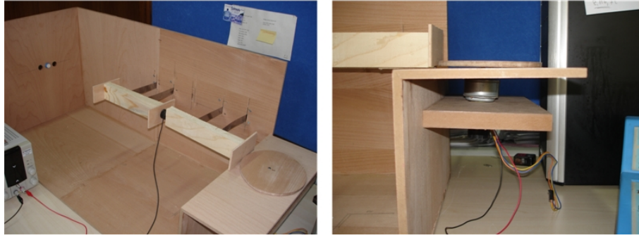
Şekil 3.16: Üretilen Esnek paralel kol mekanizmasının prototipi ve sensörler.
